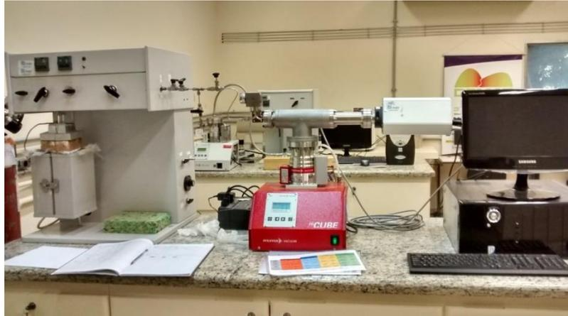
Figura 30 – Equipamento para ensaio TDS.
