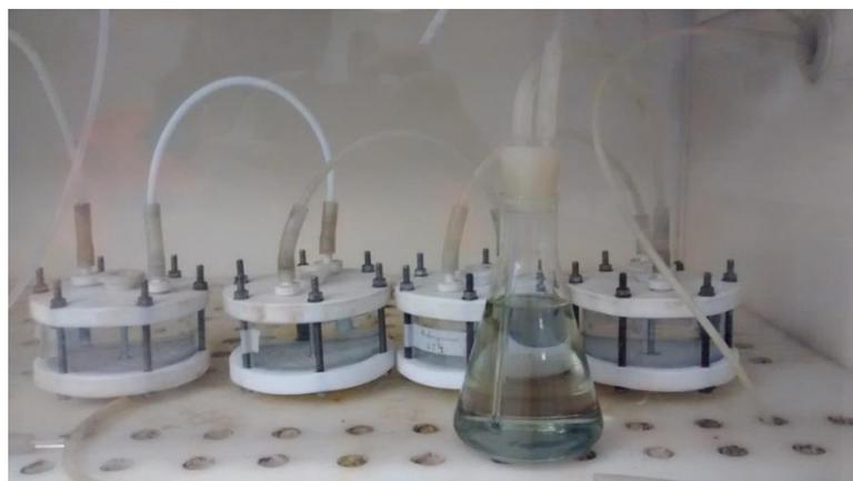
Figura 31 – Célula utilizada para o ensaio de hidrogenação com H<sub>2</sub>S.
