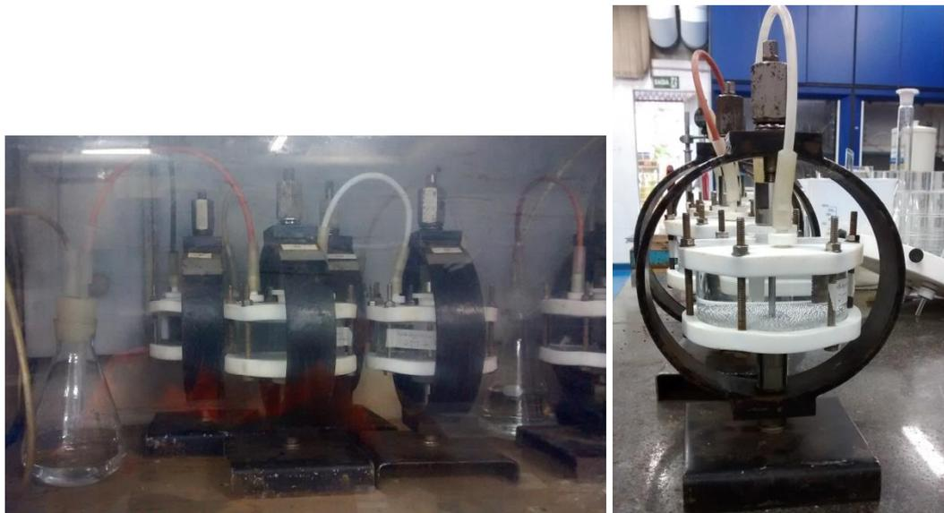
Figura 32 – Células de hidrogenação sob tensão com H<sub>2</sub>S.
