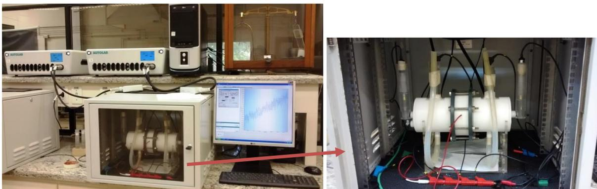
Figura 26 – Equipamento para ensaio de permeação eletroquímica.
