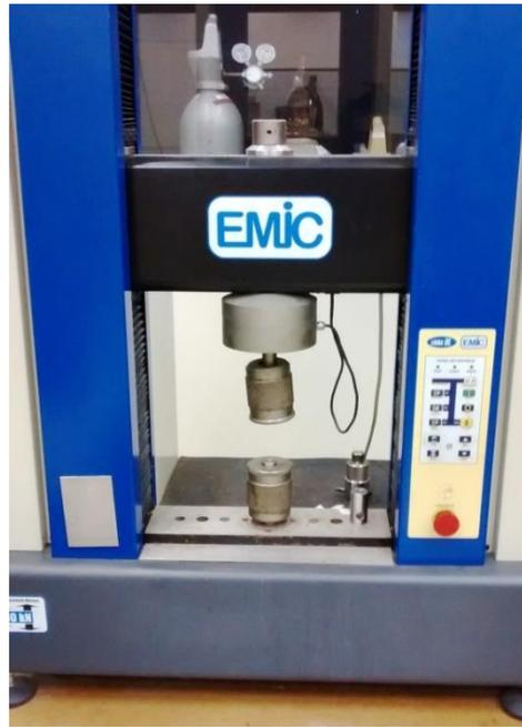
Figura 29 – Equipamento EMIC para ensaio de tração.
