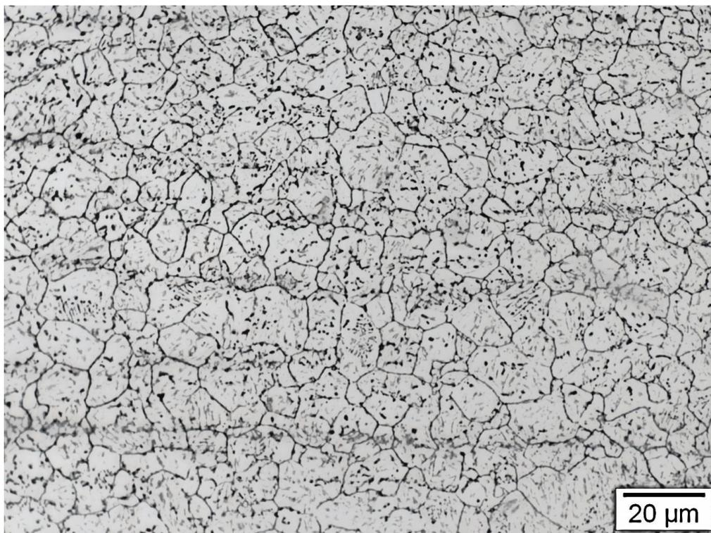
Figura 34 - Micrografia obtida em microscópio de luz visível da amostra temperada industrialmente a temperatura de 890°C, aumento de 1000X. Observam-se os grãos bem definidos da austenita prévia de grão ASTM 8,2.
