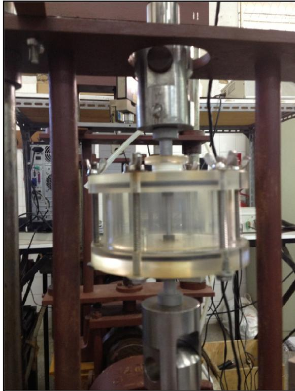
Figura 24 - Máquina de tração BTM utilizada em ensaios realizados ao ar e em solução.
