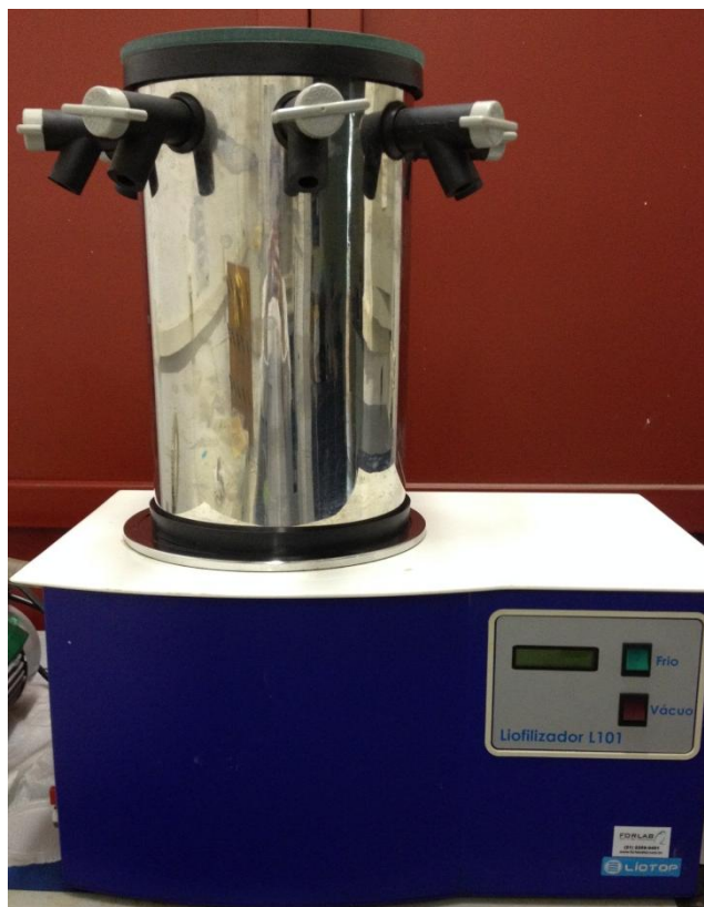
Figura 3.1: Liofilizador usado no processo de secagem das PCS.
