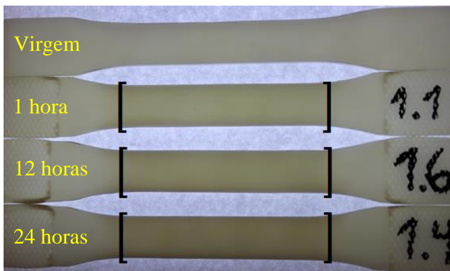
Figura 32: Mapeamento dos corpos de prova processados sem resfriamento intermediário, apresentando corpos de prova virgem e fadigado com 1, 12 e 24 horas, respectivamente.
