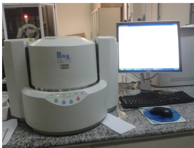
Figura 3.6- Espectrômetro de fluorescência de raios X (EDX-720)
