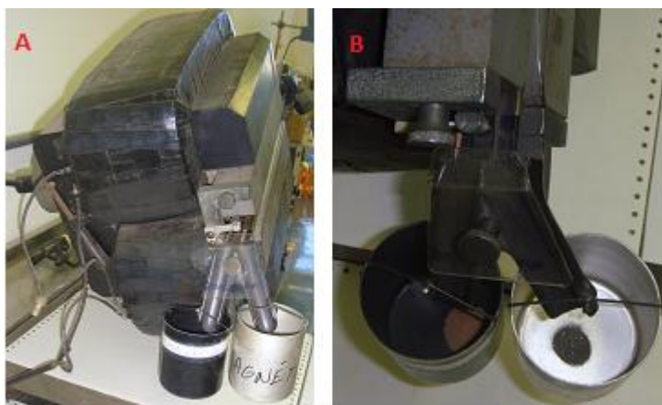
Figura 3.10- Separador magnético Frantz. Separação magnética (A), e descarga do material magnético e não magnético (B)
