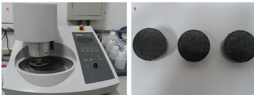
Figura 3.7- Politriz automática StruersTegra (A) e, amostras polidas (B)
