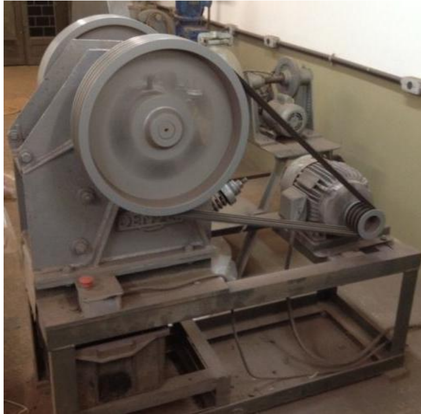
Figura 3.2- Britador de Mandíbulas DENVER 5"x6" instalado no Laboratório de Tecnologia Mineral (LTM) - UFRJ
