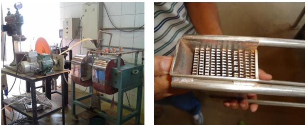
Figura 2.16- Separador Magnético Rapid
