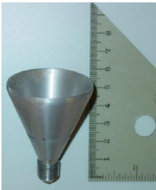
Figura 3.11- Funil de alimentação do Separador Isodinâmico Franz
