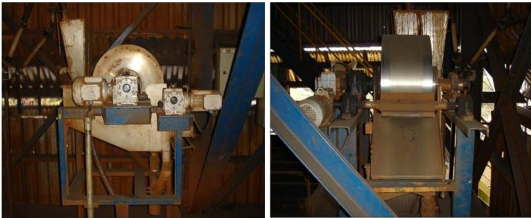
Figura 2.5- Separador magnético de tambor WDRE (Marques, 2013)
