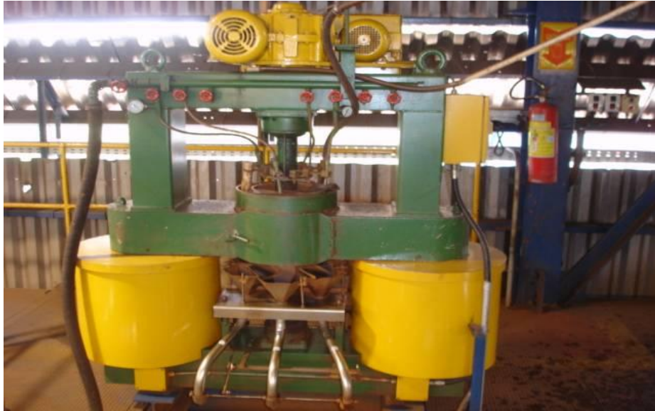
Figura 2.8-Separador magnético tipo JONES (Marques, 2013)
