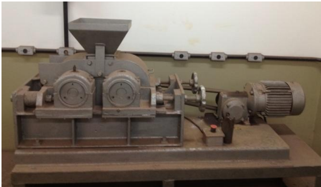
Figura 3.3- Britador de Rolos DENVER 10"x11" instalado no Laboratório de Tecnologia Mineral (LTM) - UFRJ
