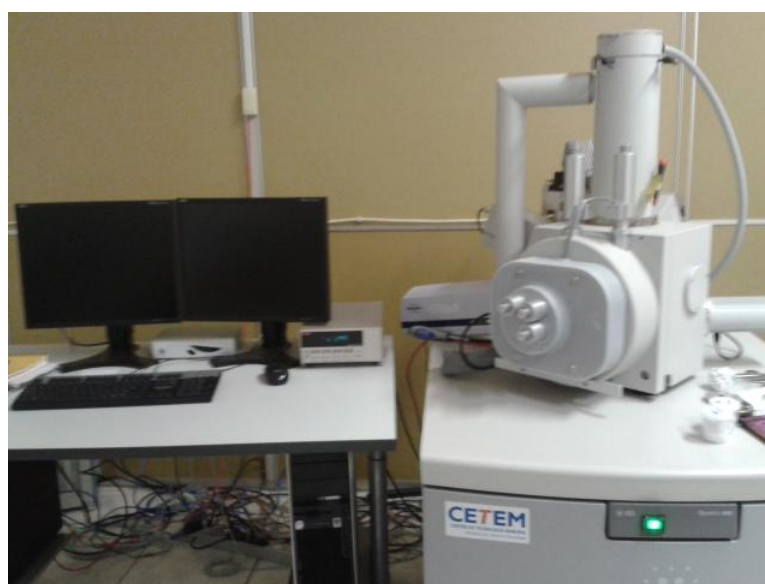
Figura 3.8- Microscópio eletrônico de varredura FEI Quanta 400 instalado no CETEM
