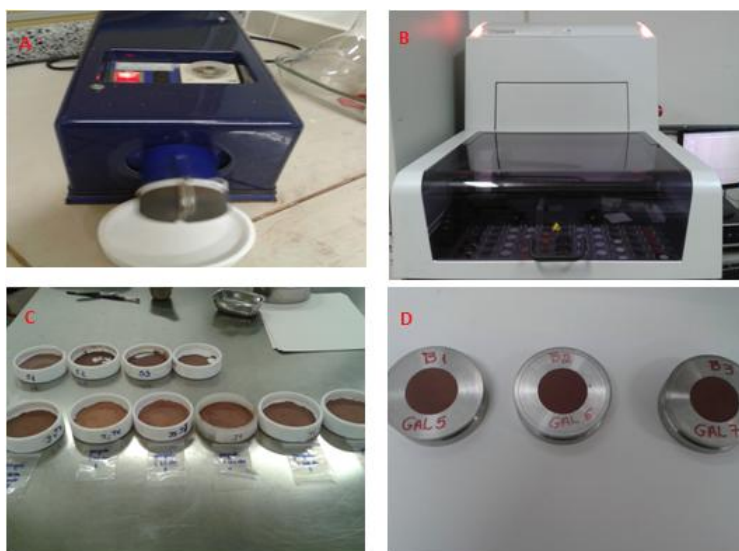
Figura 3.9- McCrone Micronizing Mill (A), DRX (B), amostras secas após a pulverização (C), Suporte para as pastilhas (D)
