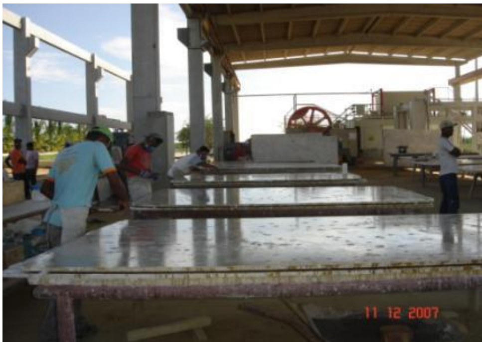
Figura 12: Resinagem das chapas do mármore Bege Bahia (RIBEIRO et al , 2011).
