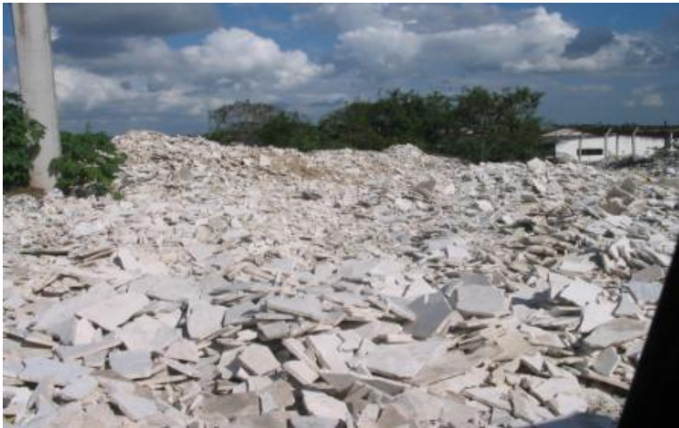
Figura 14: Resíduo grosseiro após o corte das placas descartado no meio ambiente (RIBEIRO et al , 2011).
