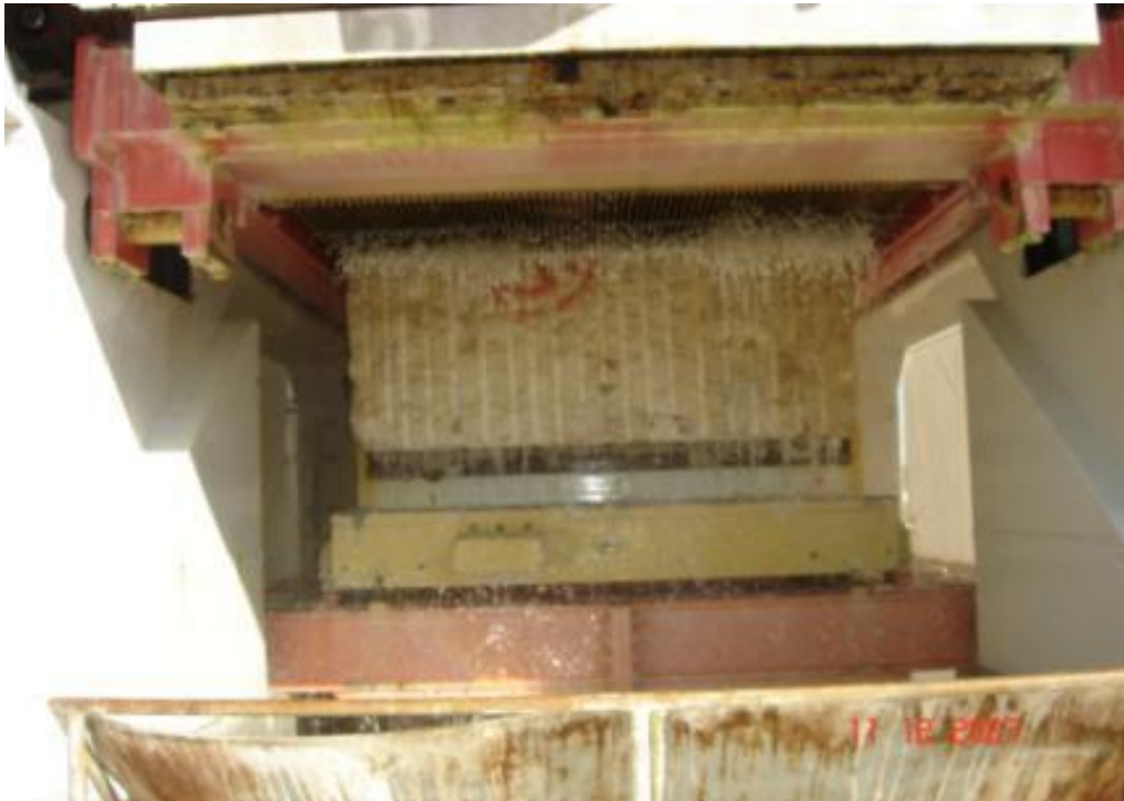
Figura 11: Formação das chapas do mármore Bege Bahia a partir dos blocos (RIBEIRO et al , 2011).
