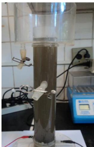
Figura 12 – Célula de eletroflotação/eletro-oxidação com efluente gerado em tanques de armazenamento de petróleo, antes da aplicação de uma diferença de potencial.
