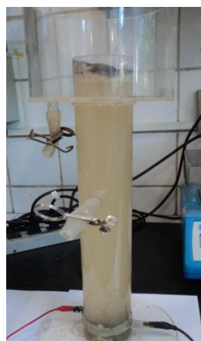
Figura 13 – Célula de eletroflotação/eletro-oxidação com efluente gerado em tanques de armazenamento de petróleo, após 30 min sob 4,5 V.
