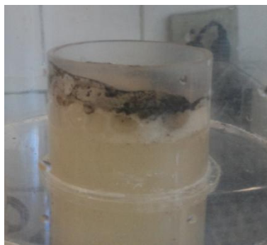
Figura 14 – Espuma e borra geradas no processo de eletroflotação/eletro-oxidação, após 30 min de ensaio sob 4,5 V
