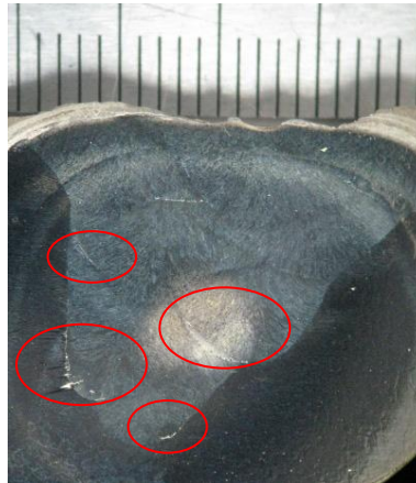
Figura 71: Macrografia da amostra 0,8 kJ/mm (todas as amostras apresentaram trincas)
