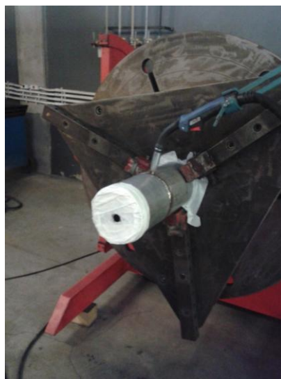
Figura 25: Tubo e equipamento utilizados na soldagem.
