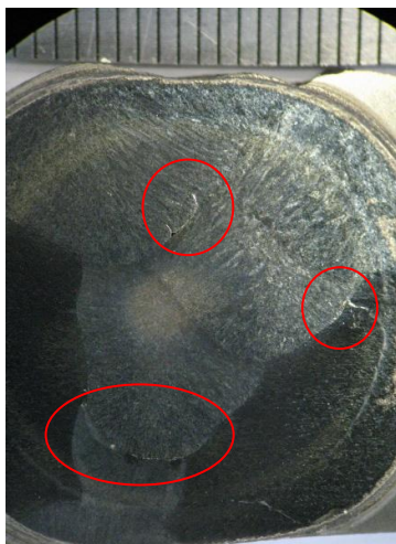
Figura 73: Macrografia da amostra 2,0 kJ/mm (todas as amostras apresentaram trincas).
