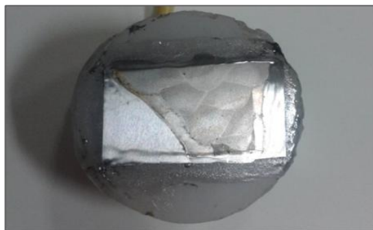
Figura 27: Região submetida ao ensaio eletroquímico DL-EPR.
