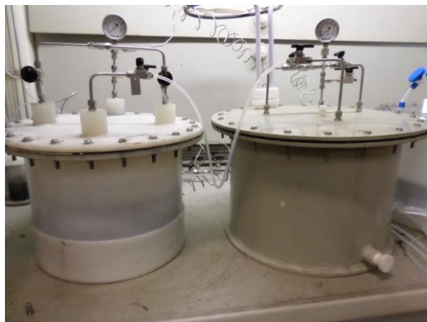
Figura 32: Células utilizadas no ensaio de corrosão sob tensão flexão em quatro pontos.
