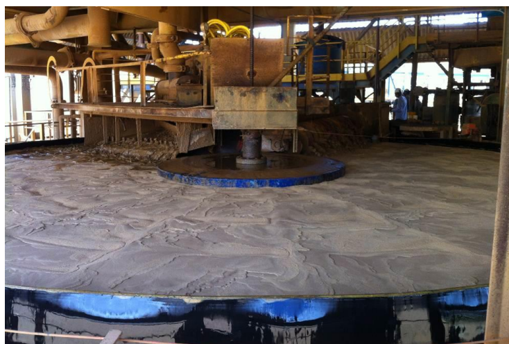
Figura 23 – Foto de um filtro plano.
