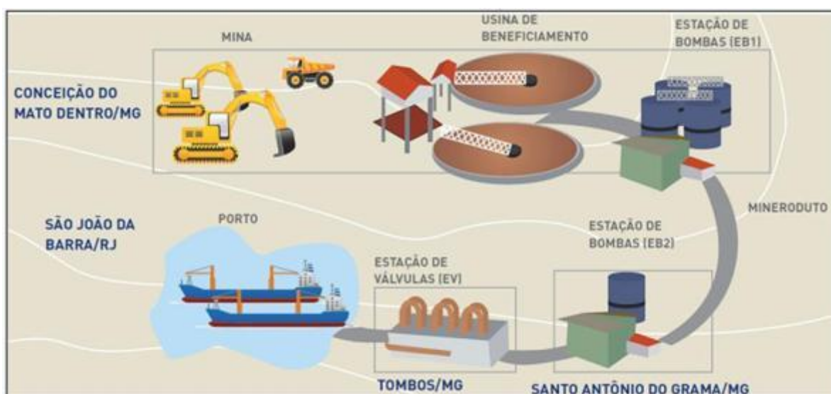
Figura 32 – Diagrama esquemático do projeto Minas-Rio (ANGLO AMERICAN, 2014).
