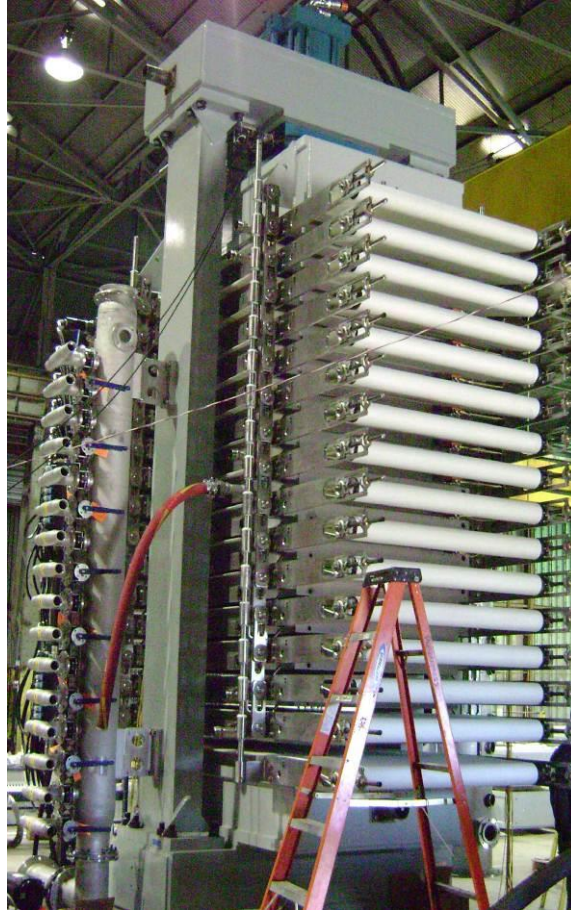
Figura 24 – Foto de um filtro prensa de placas horizontais.
