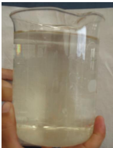
Figura 27 – Filtrado produzido em um filtro cerâmico.
