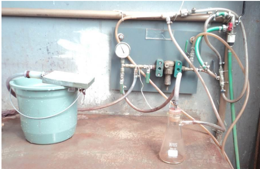
Figura 36 – Foto do leaf test utilizado nos ensaios.
