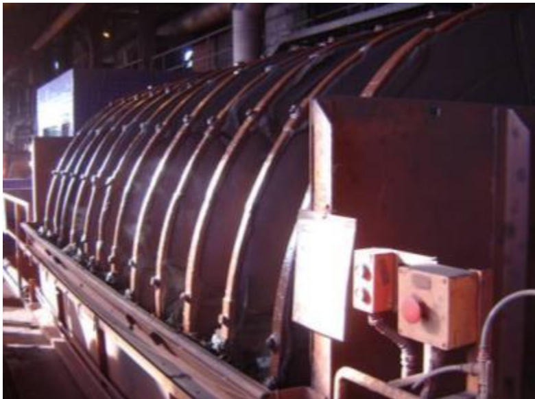
Figura 20 – Foto de um filtro de discos a vácuo.
