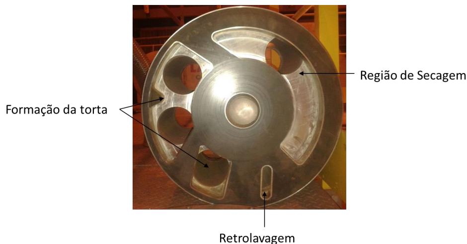
Figura 30 – Foto da válvula de distribuição de um filtro cerâmico.
