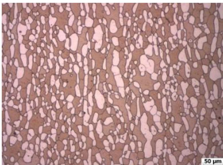
*Figura 36: Micrografia óptica da amostra DSS 02 solubilizada a 1100 °C por 1 hora.
