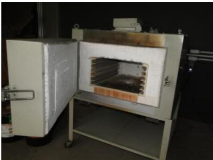
Figura 24: Forno utilizado na realização dos tratamentos térmicos
