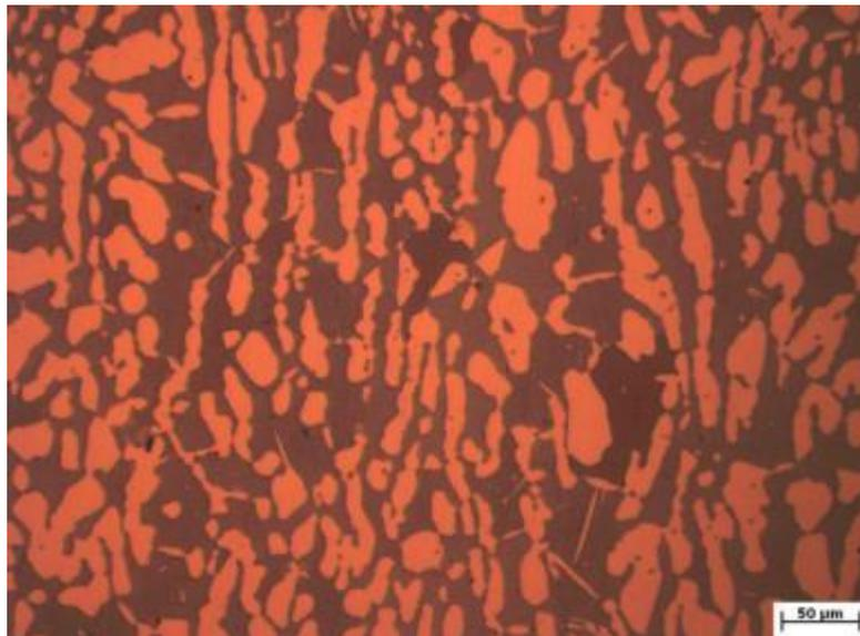
*Figura 32: Micrografia óptica da amostra DSS 01 solubilizada a 1050 °C por 1 hora. Ataque: KOH 30% (Ferrita: Fase mais escura)*
