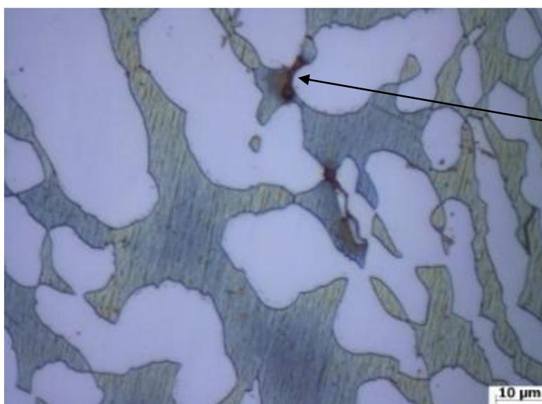
*Figura 40: Micrografia óptica da amostra DSS 03 após aquecimento a 900 °C por 20 minutos. Evidencia-se a presença de fase sigma (cor preta) precipitada em contornos ferrita/austenita. Ataque: KOH 30% (Ferrita: cor azulada / Austenita: cor branca)*
