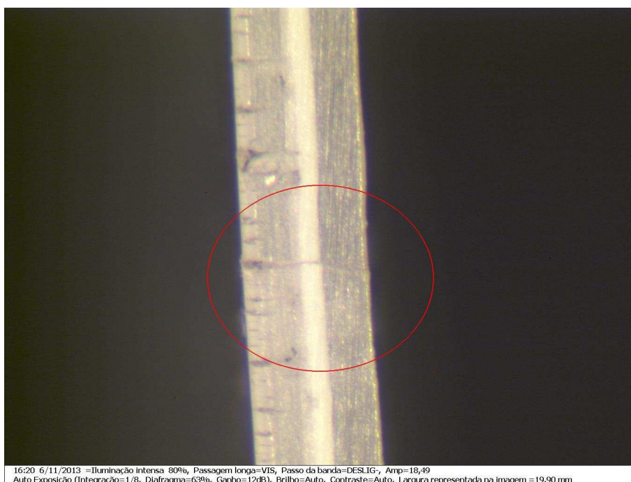
Figura 30 – Amostras de seção de cartão de policarbonato com falha ampliada
