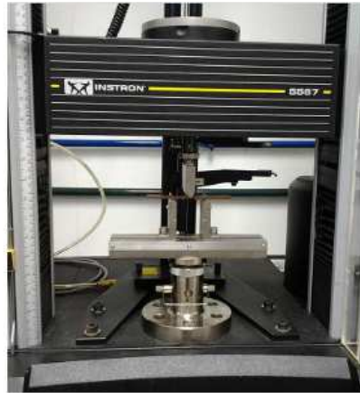
Figura 22 – Equipamento de teste de Flexão a 3 pontos – ASTM D790.
