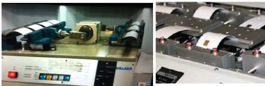
Figura 21 - Equipamento de teste de Flexão – ISO 10373-1.
