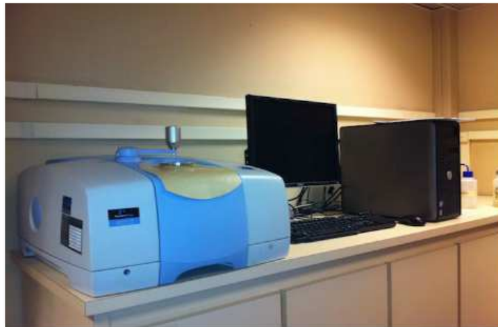
Figura 25 – Equipamento de análise FTIR – Spectrum 100 Perkin Elmer
