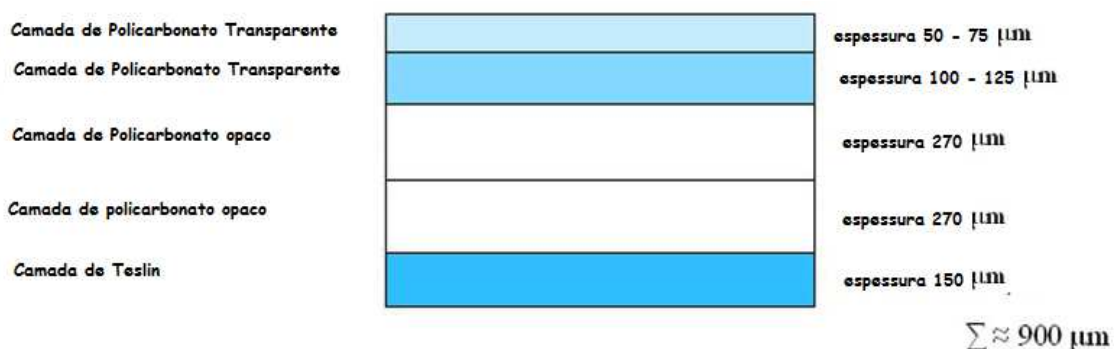
Figura 4 – Exemplo de uma estrutura de cartão de identificação formada por camadas de policarbonato. (Adaptado de Grecius, 2012)
