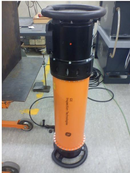
**Figura III.5** – Tubo de raios X compacto da GE – 280 kV
