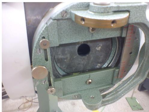
**Figura IV.13** – Feixe do tubo de 420 kV colimado com placas de chumbo
