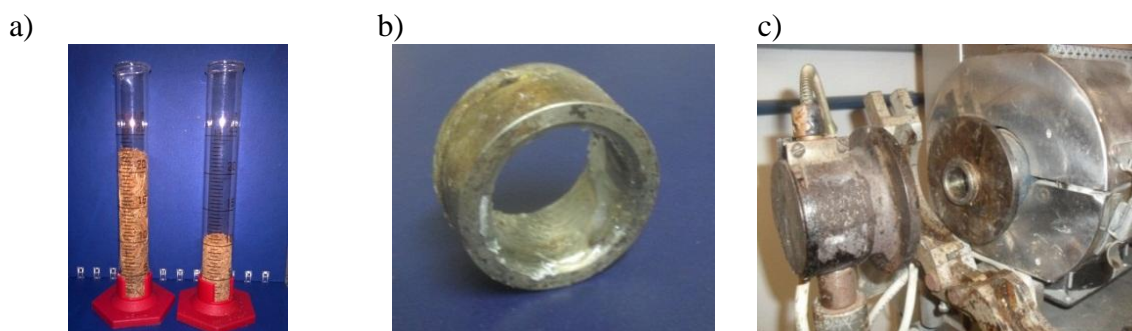
Figura 27 – Alterações realizadas: redução do tamanho das fibras (a), peça substituta do regulador de fluxo (b) e seu posicionamento na extrusora (c).
