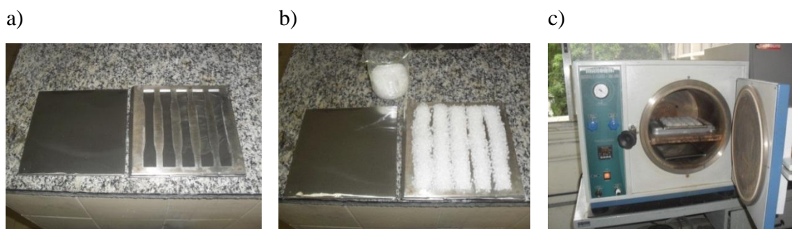
Figura 24 – Conjunto de moldagem de corpos de prova tipo I (a) preenchido pelos pellets da amostra (b) e sua inserção na estufa a vácuo (c).
