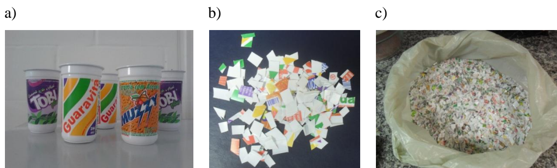
Figura 20 – Copos utilizados para envasar guaraná natural (a), pedaços picotados (b) e o lote gerado (c).
