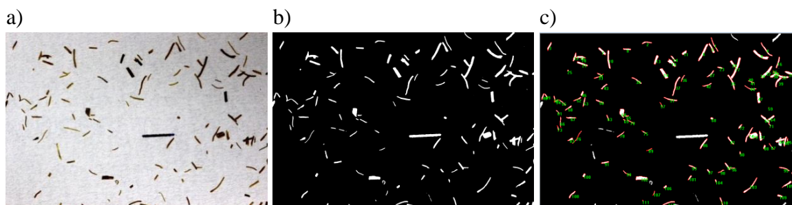
Figura 28 – Análise do tamanho das fibras pelo software Image Pro Plus 6.0: Foto das fibras espalhadas em superfície branca (a), binarização da imagem (b) e contagem e análise de tamanhos (c).
