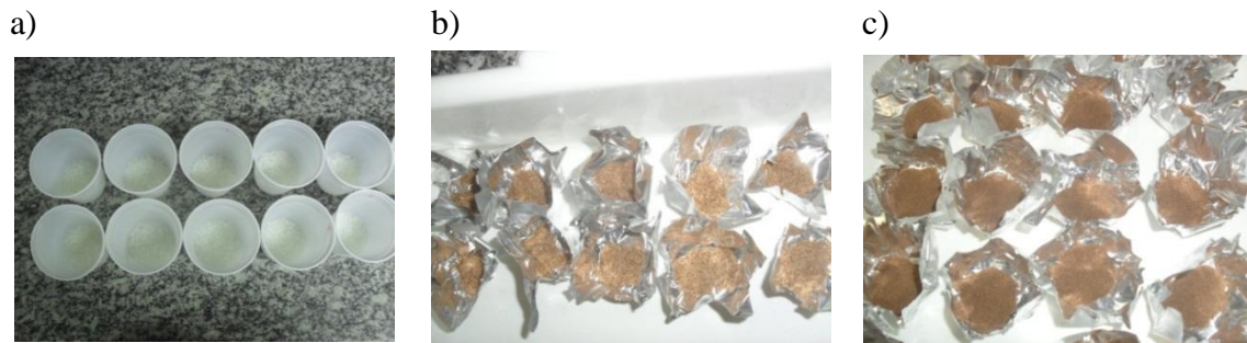
Figura 34 – Componentes dos compósitos divididos em porções: polímero da matriz (a), fibra de coco (b) e pó de coco (c).
