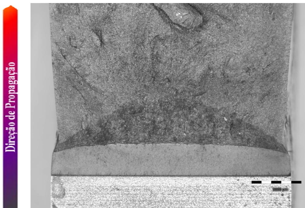
Figura 76 - Análise fractográfica por microscopia estereoscópica da superfície de fratura de corpo de prova do metal de base do aço LCN ensaiado a -40°C. Observa-se que a extensão da região de propagação estável é considerável.
