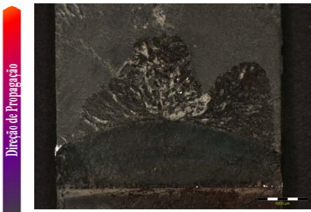
Figura 86 - Análise fractográfica por microscopia estereoscópica do corpo de prova da linha de fusão do aço LCN ensaiado a  $-20^{\circ}\text{C}$ . Superfície de fratura submetida a tingimento térmico. Fratura frágil.
