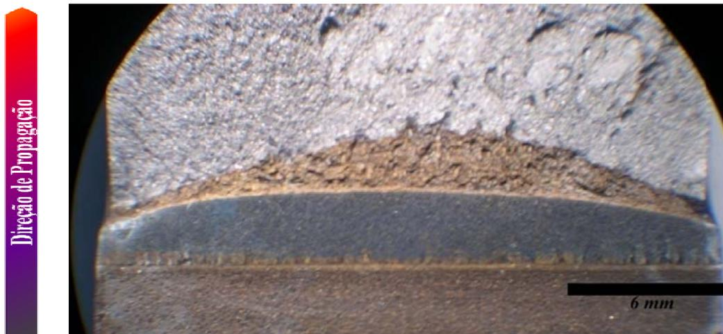
Figura 91 - Análise fractográfica por microscopia estereoscópica do corpo de prova da região da linha de fusão da junta soldada do aço CLC ensaiado a  $-20^{\circ}\text{C}$  e submetido a tingimento térmico. Fratura dúctil.
