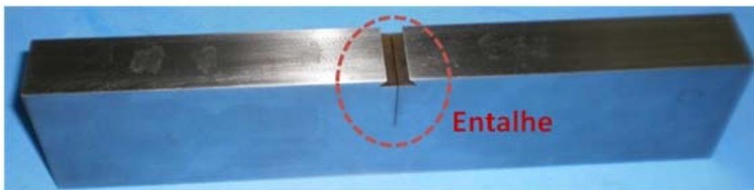
Figura 17 - Corpo de prova SE(B) entalhado.
