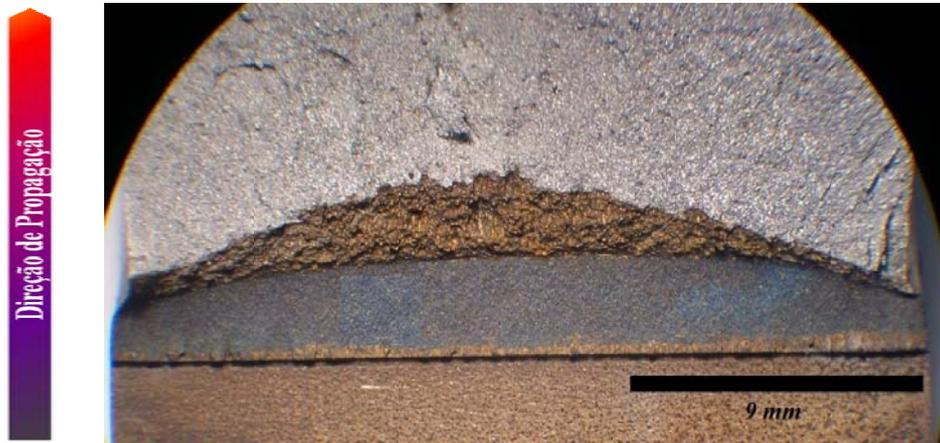
Figura 78 - Análise fractográfica por microscopia estereoscópica do corpo de prova do metal de base do aço CLC ensaiado a  $-20^{\circ}\text{C}$ . A região de fratura dúctil pode ser vista.
