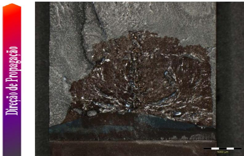
Figura 88 - Análise fractográfica por microscopia estereoscópica do corpo de prova da linha de fusão do aço LCN ensaiado a  $-40^{\circ}\text{C}$ . Superfície de fratura submetida a tingimento térmico. Vê-se, na direção de propagação, a transição do crescimento da trinca de fadiga para propagação instável, aparentemente, sem região de propagação dúctil.
