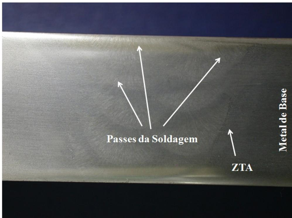
Figura 33 - Regiões da junta soldada do aço CLC no corpo de prova SE(B). Vê-se o metal de base, a ZTA e os passes de soldagem.
