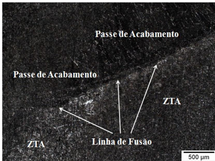
Figura 43 - Região da interface entre a ZTA e o metal de base do aço LCN próxima ao passe de acabamento, obtida por microscopia óptica. Aumento de 50x.
