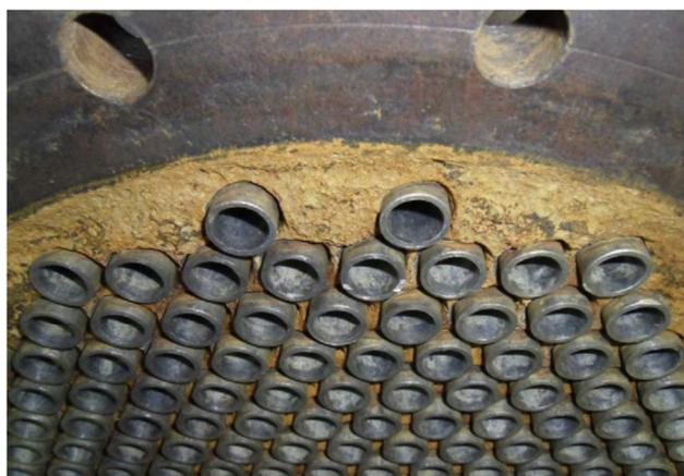
Figura 2.14 - Corrosão galvânica no espelho em aço carbono com tubo de aço inoxidável austenítico
