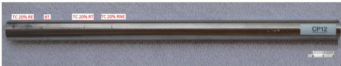
Figura 3.12 - Foto do CP 12 com 03 TC 20% da espessura do tubo
