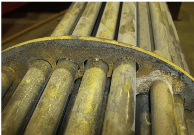
Figura 2.15 - Detalhes do contato do tubo com a chicana mostrando o desgaste devido a folga excessiva
