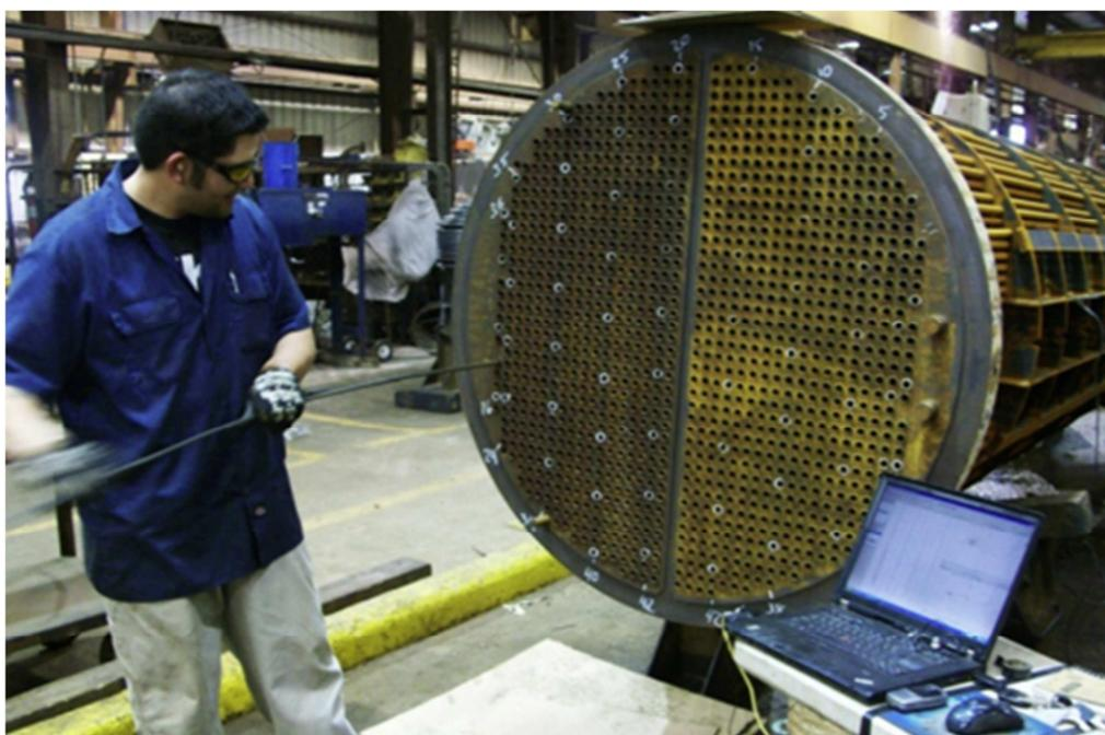
Figura 2.46 - Esquema de execução do ensaio de correntes parasitas
