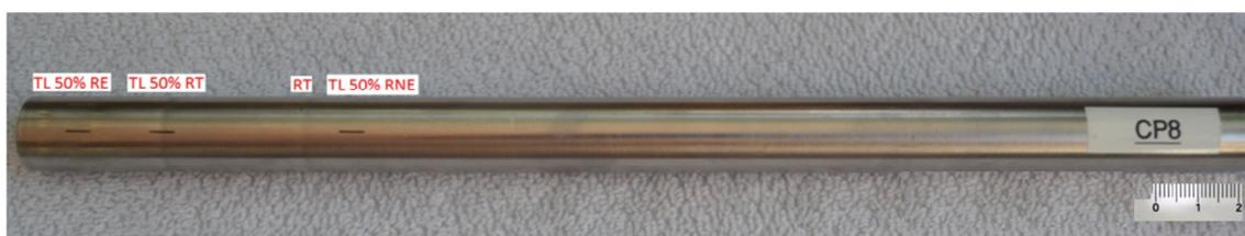
Figura 3.8 -Foto do CP 8 com 03 TL 50% da espessura do tubo
