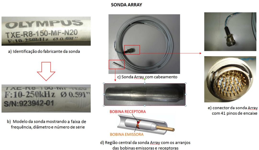
Figura 3.16 - Principais características da sonda bobina utilizada
