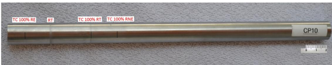
Figura 3.10 - Foto do CP 10 com 03 TC 100% da espessura do tubo
