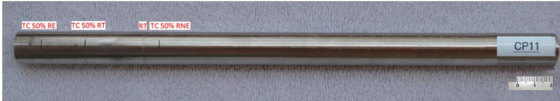
Figura 3.11 - Foto do CP 11 com 03 TC 50% da espessura do tubo
