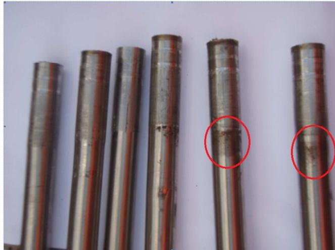
Figura 2.13 - Tubos de aço inoxidáveis AISI 321 com indicação de corrosão nas frestas da RNE
