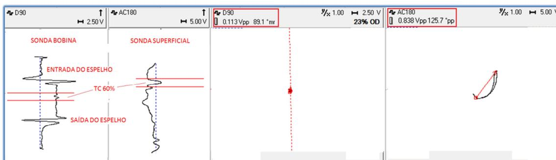
Figura 4.40 - Sinal da TC 60% do padrão com a sonda *Pancake* dentro do espelho
