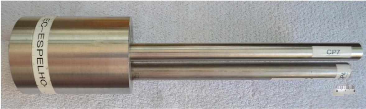
Figura 3.20 - CP7 com trinca TL 100% dentro do espelho
