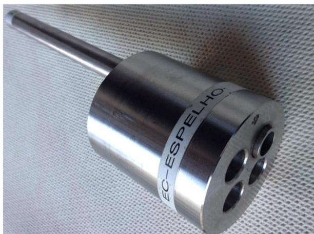
Figura 3.4 - Foto do CP 4 inserido no espelho
