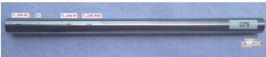
Figura 3.9 - Foto do CP 9 com 03 TL 20% da espessura do tubo
