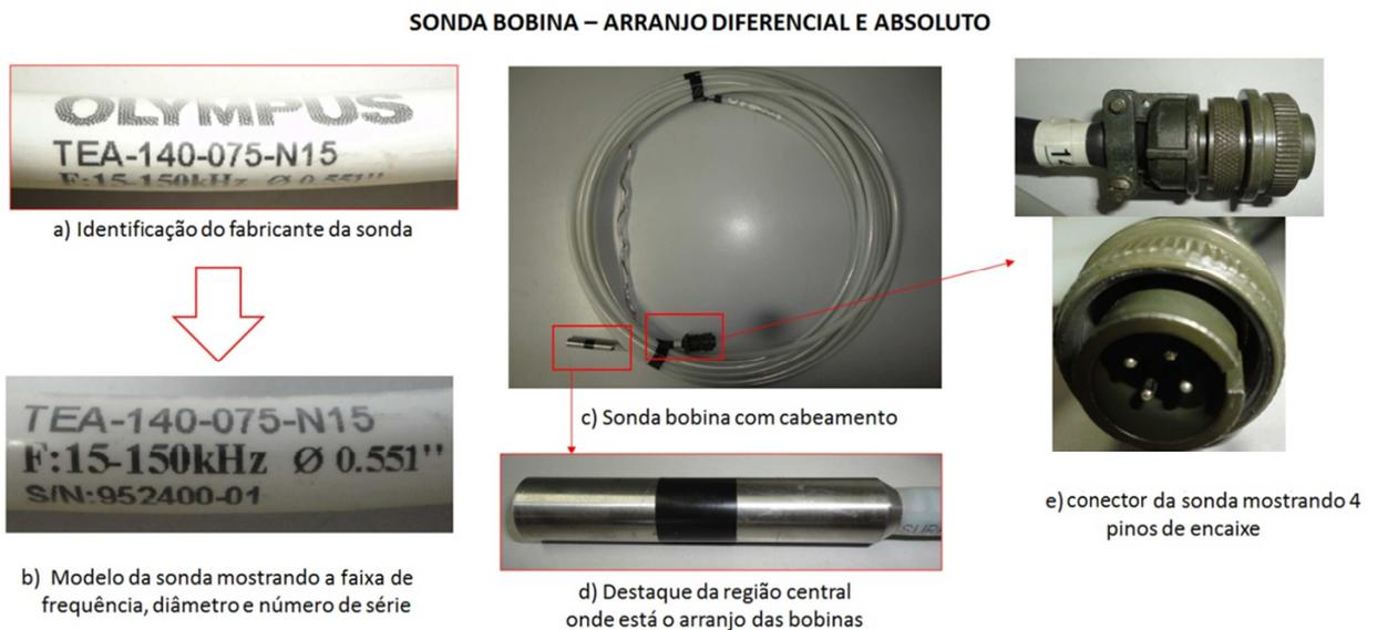
Figura 3.14 - Principais características da sonda bobina utilizada
