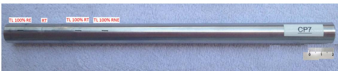
Figura 3.7 - Foto do CP 7 com 03 TL 100% da espessura do tubo
