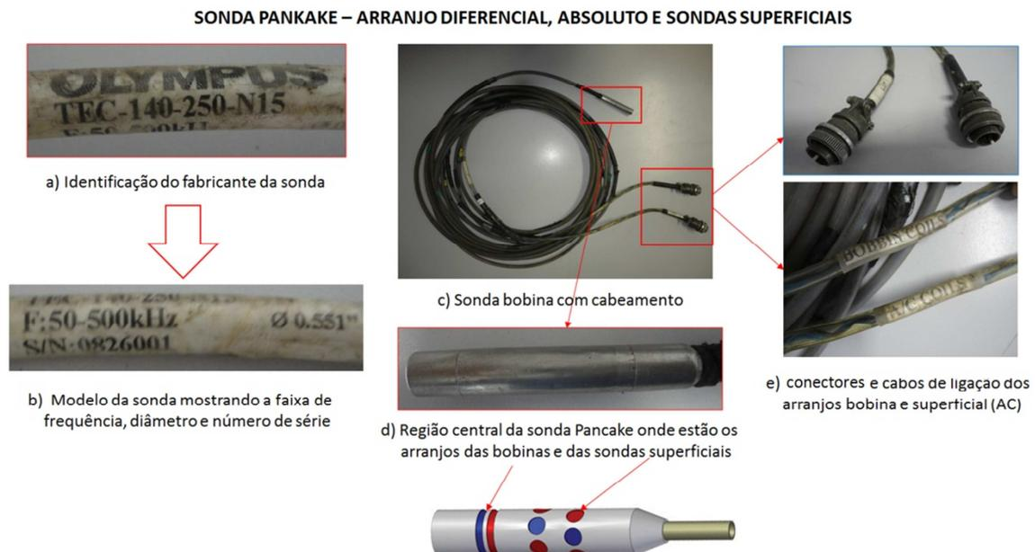
Figura 3.15 - Principais características da sonda *Pancake* utilizada
