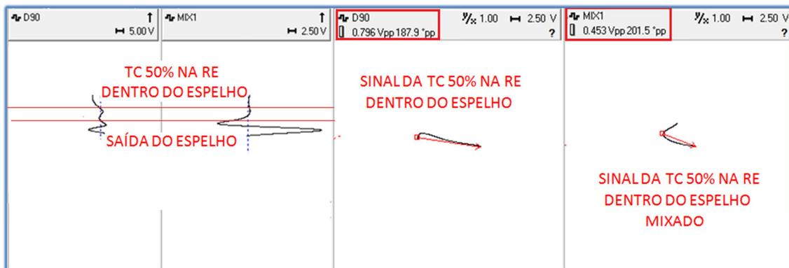
Figura 4.37 - Sinal da TC 50% na RE dentro do espelho
