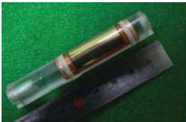
Figura 2.44 - Modelo de arranjo cilíndrico para as sondas com sensores *Hall*
