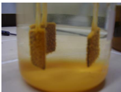
Figura 5.15: Foto do ensaio de perda de massa para o aço-carbono 1020 em solução neutra sem extrato depois de 120 horas de imersão a 25 °C.
