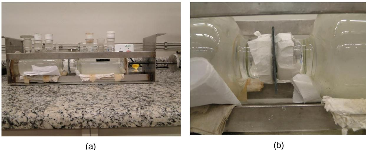
**Figura 26** – (a) Célula de vidro para medir impedância de filmes em diferentes temperaturas, (b) detalhe do filme livre entre os compartimentos de vidro.
