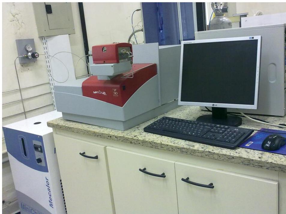
Figura 25 - Imagem do equipamento de DSC montado no laboratório PROPMEC/UFRJ.
