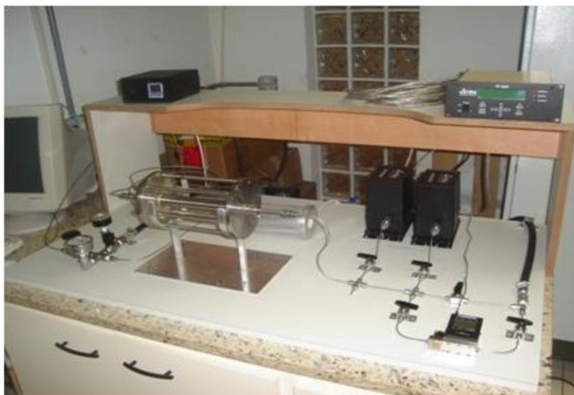
Figura 26 - Foto do equipamento utilizado para permeação gasosa de hidrogênio montado na PROPMEC/UFRJ.
