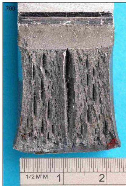
**Figura 12** - Superfície de fratura apresentando delaminações (*splits*) [15].
