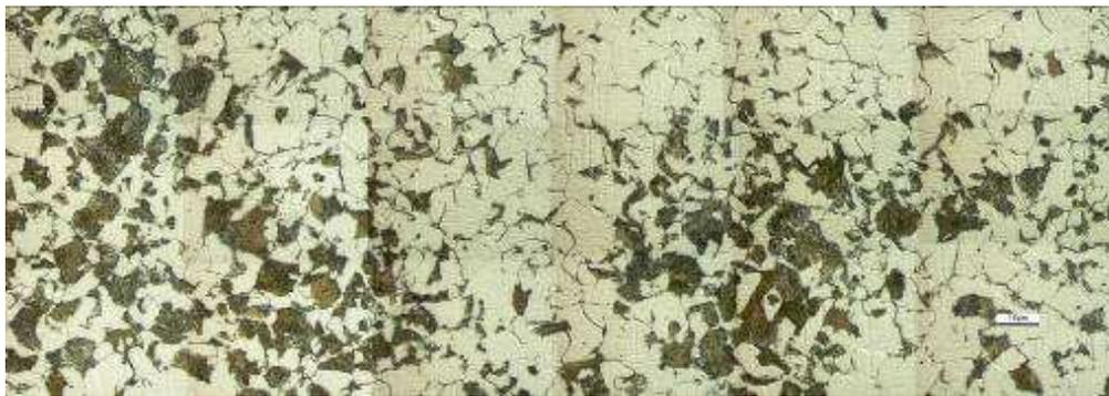
**Figura 80** - Micrografia do aço LCN25, 1000X.
