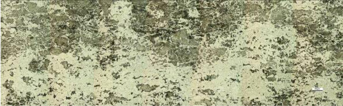
**Figura 74** - Distribuição da bainita na metade da espessura no aço CLC25. Nital 2%, 200X.
