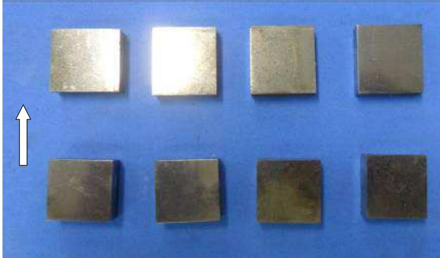
**Figura 50** - Amostras para difração de raios X, com a seta à esquerda indicando a direção de laminação.
