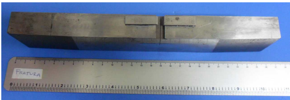
Figura 36: Foto do corpo de prova com dois jogos de facas porta-clip, para aumentar a faixa de medição do extensômetro.
