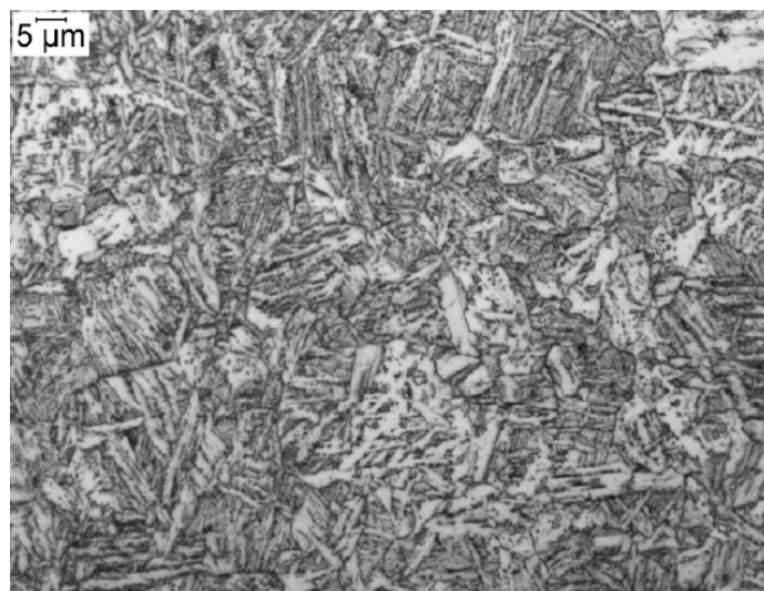
Figura 14: Ferrita poligonal nucleada no interior do grão austenítico [11].
