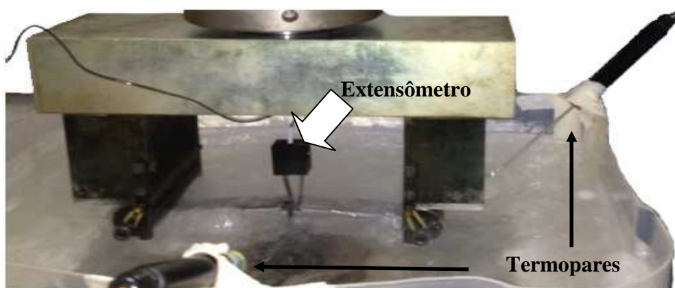
Figura 35: Teste de tenacidade à fratura a -20^{\circ}\text{C} .
