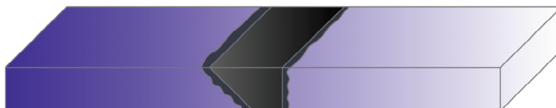
Figura 32: Esquema da amostra atacada para o posicionamento do entalhe.
