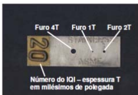
Figura 12. Indicador da Qualidade da Imagem ASTM tipo placa [8].
