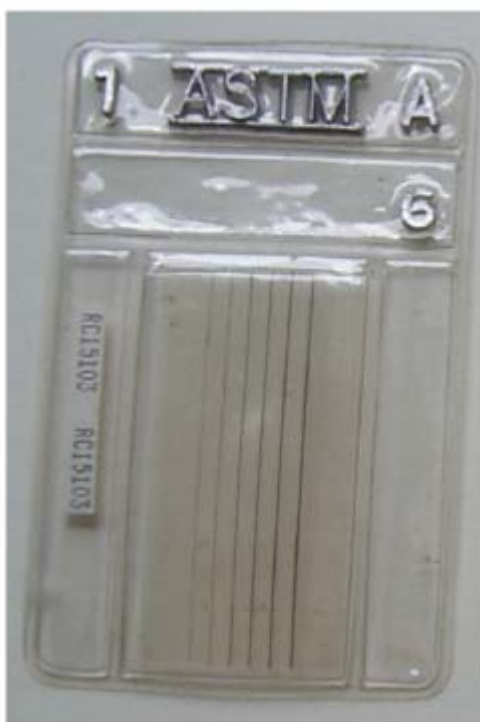
Figura 13. Indicador da Qualidade da Imagem ASTM tipo fio [8].
