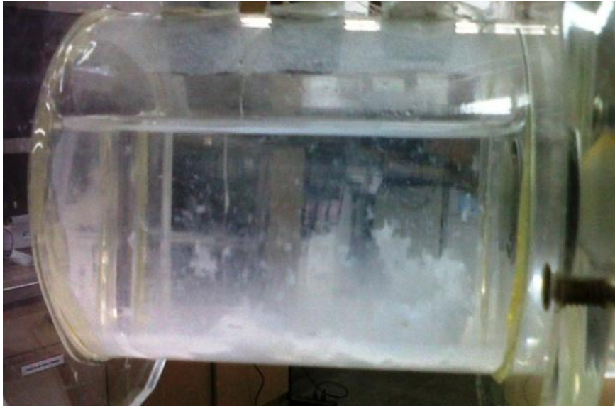
Figura IV.29: Solução que recebeu a injeção da urotropina ao final do ensaio. É possível observar um precipitado branco que acredita-se ser a tritiane produzida pela reação do H_2S com o formaldeído.
