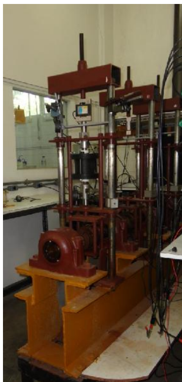
Figura III.9: Máquina de tração BTM utilizada para testar os sequestrantes.
