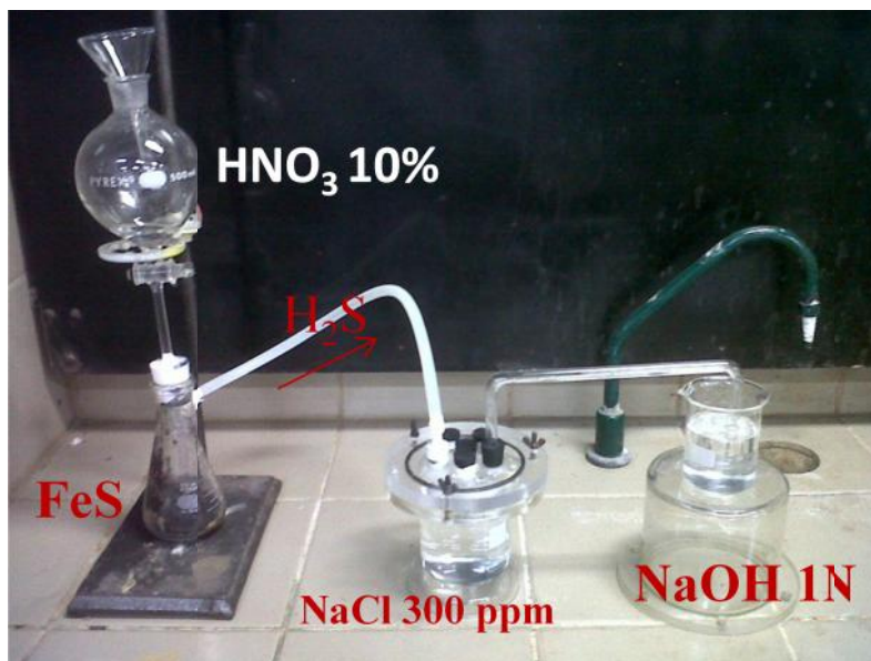
Figura III.3: Sistema utilizado para gerar H_2S a partir da reação entre o sulfeto de ferro e o ácido nítrico.
