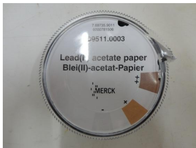
Figura IV.6: Colorações apresentadas pelo papel acetato de chumbo utilizado para verificar a ocorrência das reações de sequestro.
