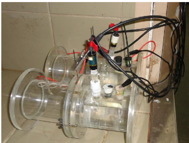
Figura III.14: Célula de acrílico utilizada nos ensaio de permeação.
