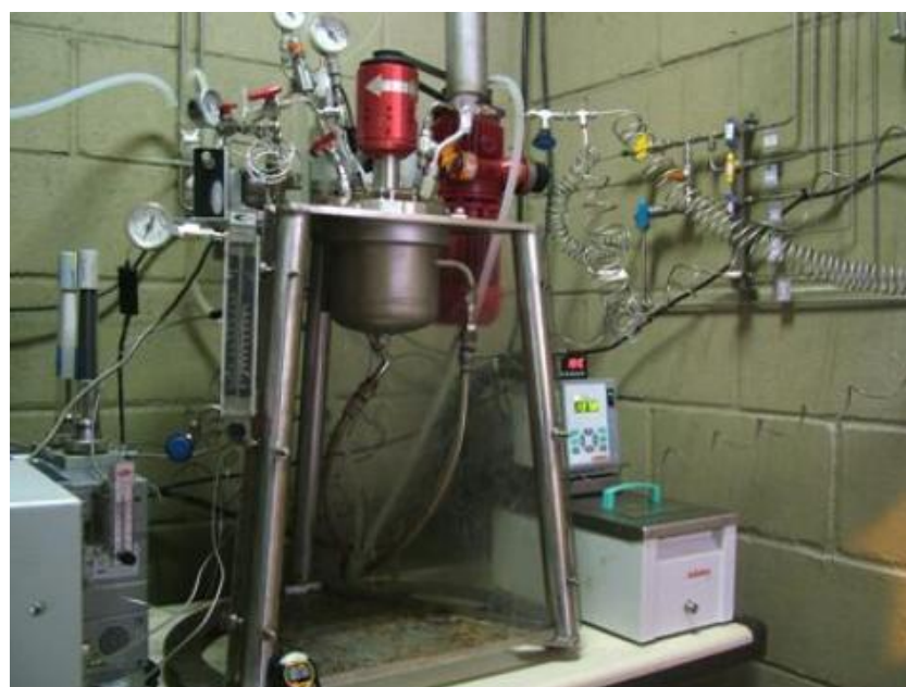
Figura II.19: Foto ilustrativa do aparato de teste utilizado por Magalhães e Bonfim para teste dos sequestrantes em alta temperatura [30].
