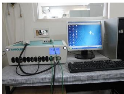
Figura III.10: Potenciostato /galvanostato da Metrohm, modelo Autolab 302-N utilizado para fazer as curvas de polarização do aço L-80 nas soluções testadas.
