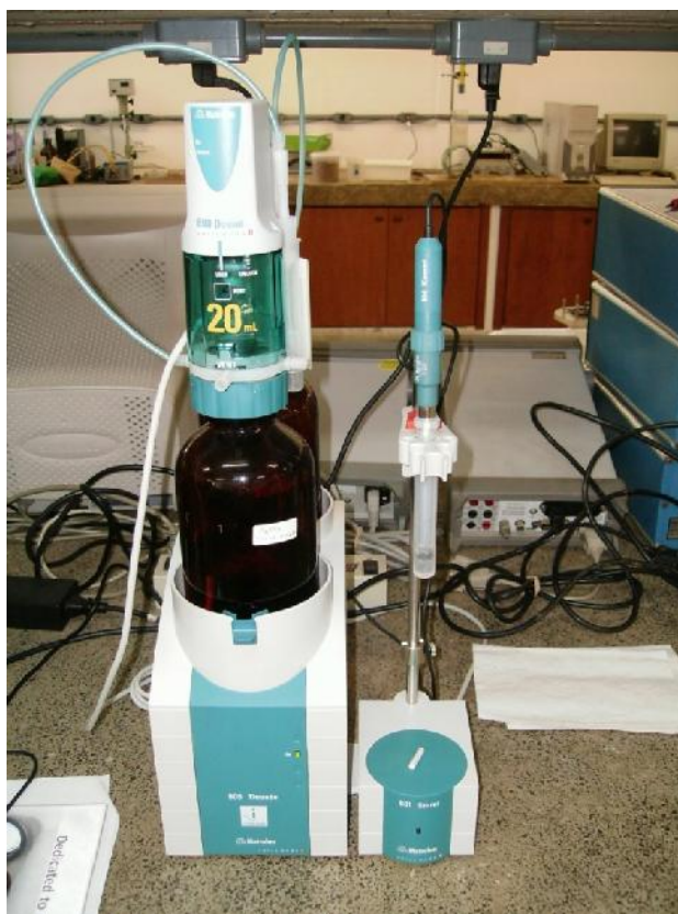
Figura III.1: Titulador potenciométrico utilizado nas análises.
