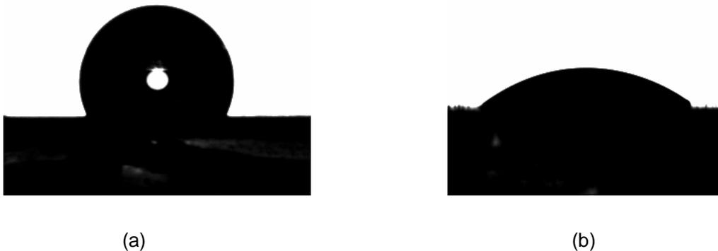
**Figura 2.12** - Gota de água em superfície hidrofóbica e em superfície hidrofílica (SANTOS *et al.*, 2011).
