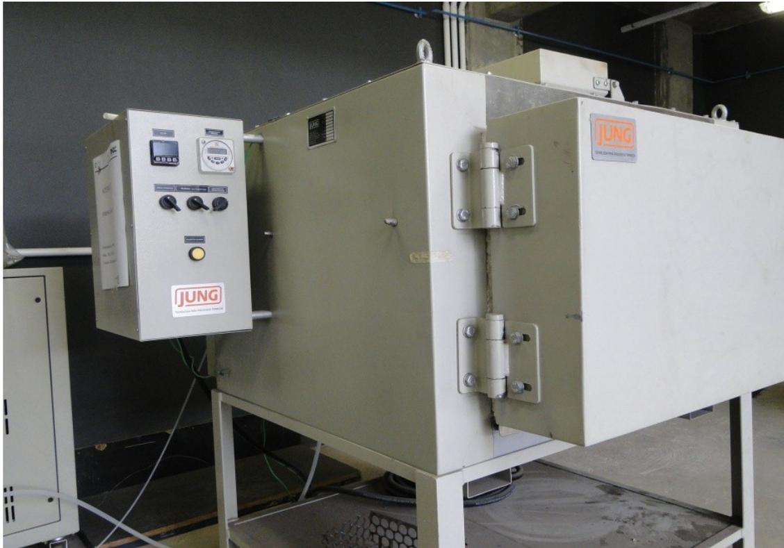
Figura 14. Forno elétrico utilizado nos tratamentos térmicos das amostras.
