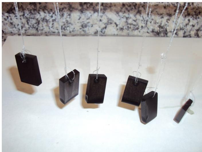
Figura 45. Amostras retiradas após o término do ensaio de 28 h em solução 3 M *HCl*. As duas amostras da esquerda são solubilizadas a 1.120 °C, as duas centrais são solubilizadas a 1.220 °C, e as duas da direita são solubilizadas a 1.300 °C.
