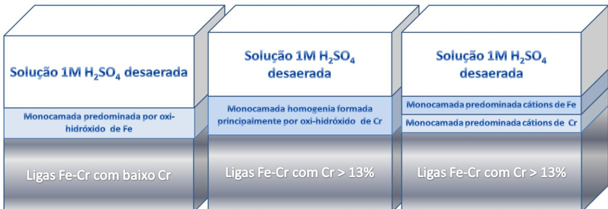
Figura 1. Estrutura do filme passivo de ligas *Fe – Cr* em solução *H<sub>2</sub>SO<sub>4</sub>* desaerada. a) monocamada formada em ligas com baixo cromo. b) Hipótese de monocamada em ligas com alto cromo. c) Hipótese de dupla camada, a interna rica em *Cr* e a externa rica em *Fe*. Adaptado de ASAMI et al. (1978).
