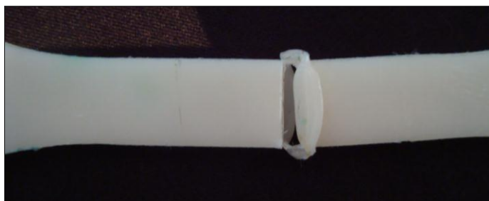
Figura 14 – Corpo de prova com cordão de solda, e sem solda no interior, condição de processamento C e de solda 1.
