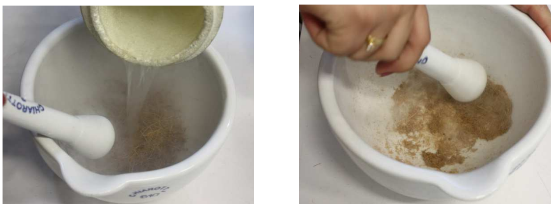
Figura 3.4 – Fibras reduzidas por processo de criogenia.
