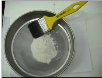
Figura 11 - Vitrocerâmica na peneira de aço inox de 325 malhas para obtenção de granulometria de 45\mu\text{m} .
