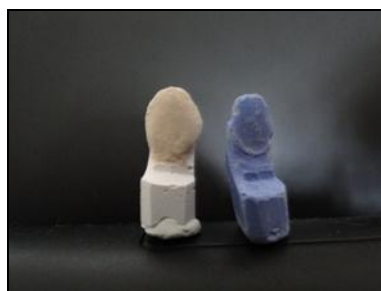
Figura 57- Infraestrutura sinterizada de compósito cerâmico de mica moscovita com 20% e temperatura de patamar de 850°C posicionada no modelo mestre.
