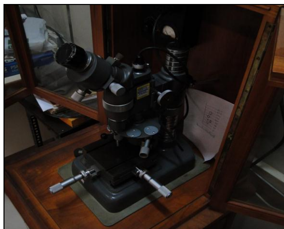
Figura 19- Microdurômetro da marca Leitz Durimet 2® (PEMM/COPPE/UFRJ).
