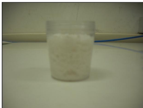
Figura 8 - Vidro-cerâmica depois de retirada do cadinho (vista lateral).
