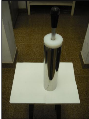
Figura 9 - Triturador manual utilizado para diminuição de granulometria da vitrocerâmica.
