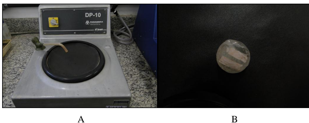
Figura 18 - A- Equipamento de preparação das amostras (lixamento / polimento) DP-10 (Panambra®); B - Barras de compósito cerâmico, embutidas após as etapas de lixamento / polimento.
