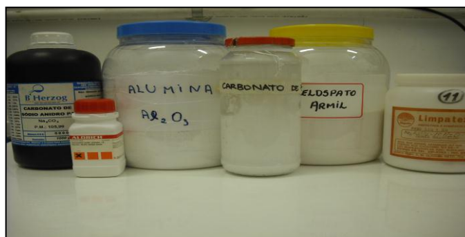
Figura 5 - Feldspatos e outros minerais brasileiros usados para a obtenção de vitrocerâmica.
