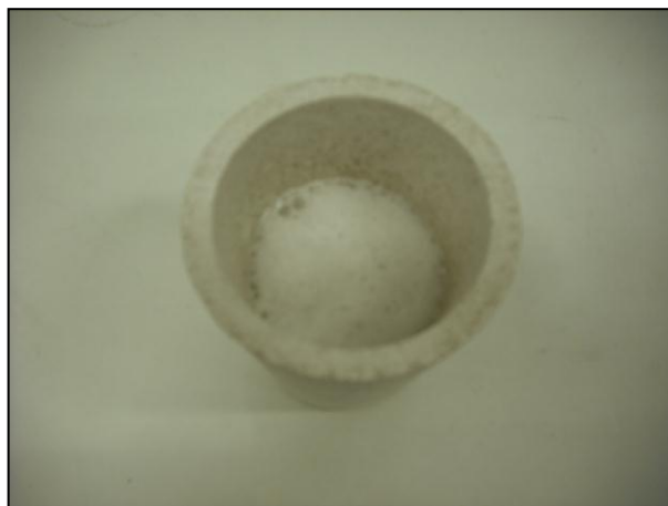
Figura 7 - Fundição de vidro-cerâmica feldspática (vista superior).
