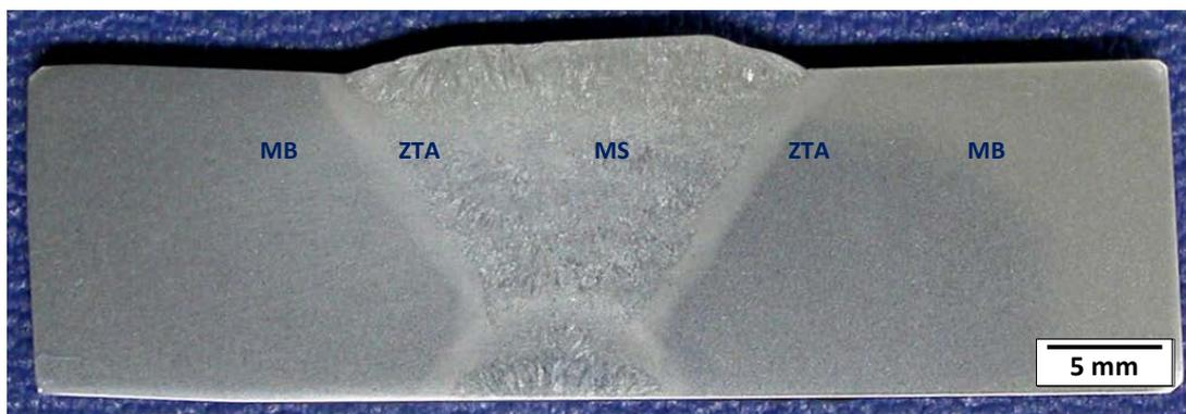
Figura 4.8. Macrografia da seção transversal da amostra JST3-1. Nota-se a ausência de defeitos na junta soldada.
