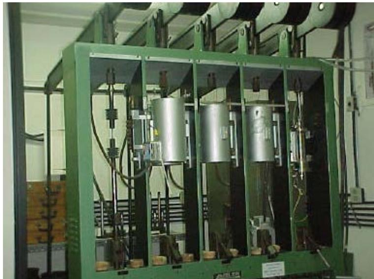
Figura 3.17. Vista geral da máquina de ensaios de fluência Amsler.
