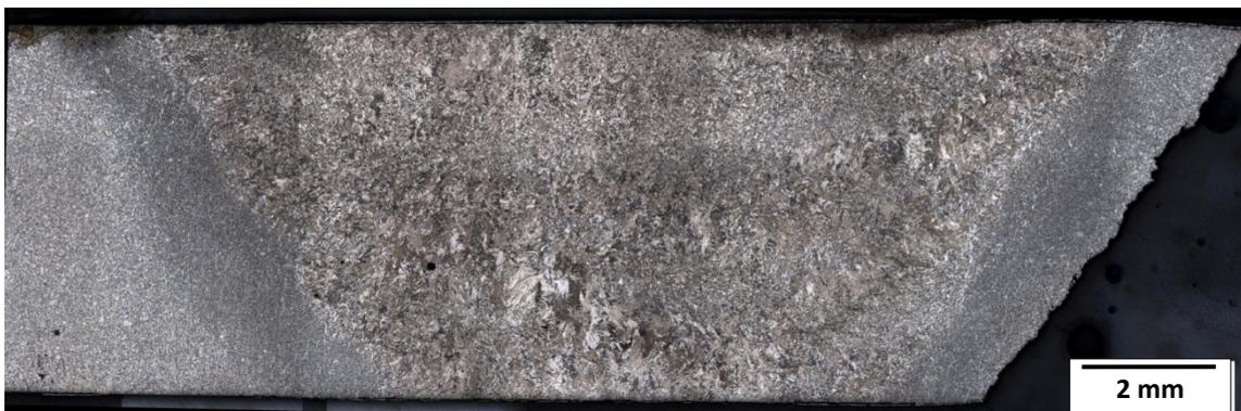
Figura 4.48. Macrografia da amostra rompida em fluência por fratura do tipo IV.
