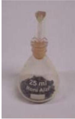
**Figura III-1 – Picnômetro preenchido com uma amostra de material particulado
