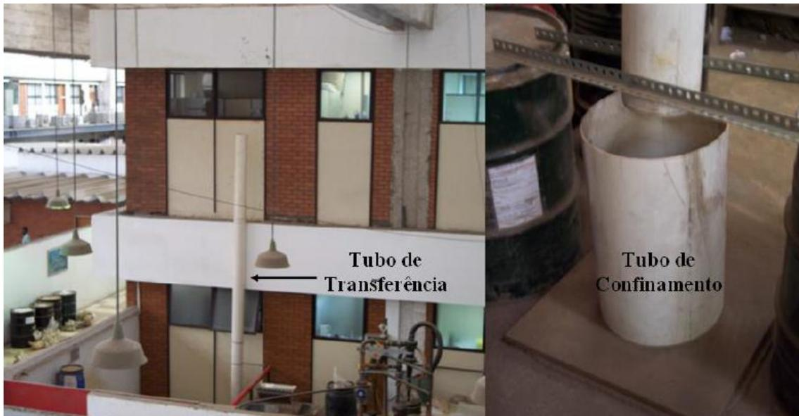
**Figura III-9 – Fotos ilustrativas do sistema de queda livre montado no LTM (COPPE/UFRJ) para simulação de uma etapa de manuseio.**
