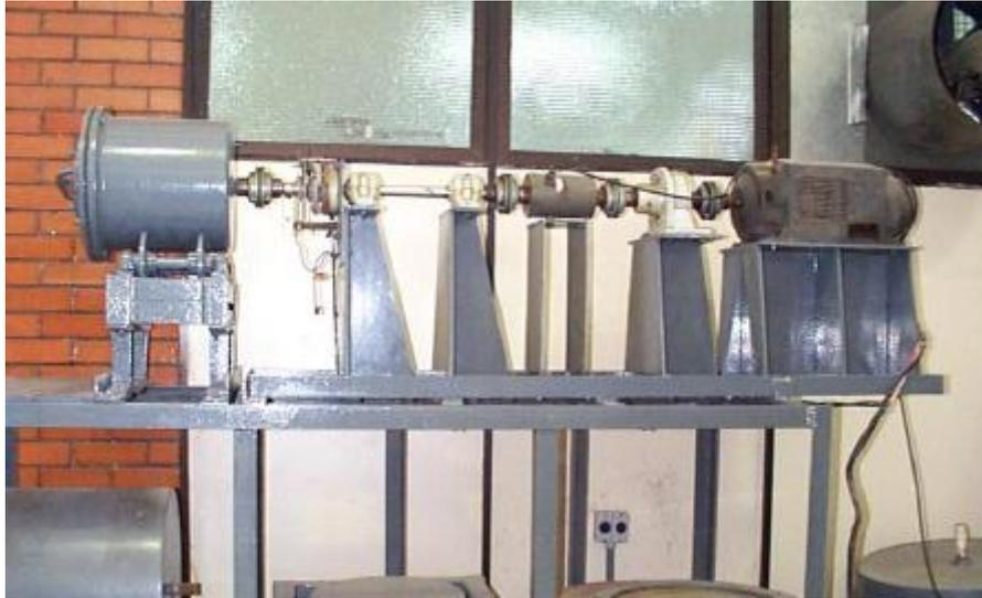
**Figura III-7 – Moinho tubular de 30 cm x 30 cm, usado nos ensaios de abrasão adaptados do padrão JKMRC (LTM/COPPE)**
