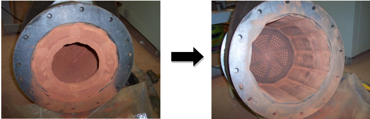
Figura 2-21 - Comparação entre o moinho entupido e limpo
