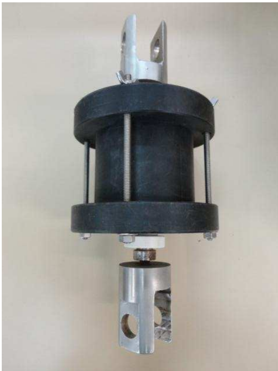
Figura 44- Foto da célula montada com o corpo de prova internamente.
