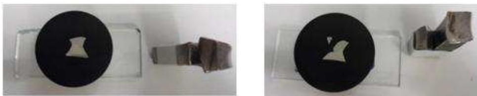
Figura 3.25: Exemplos de corpos-de-prova submetidos ao ensaio de dobramento cortados para detecção de trincas microscópicas na região da ZAC e atacados segundo a norma ASTM A-262 - Prática A.
