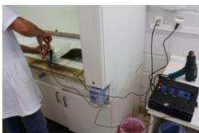
Figura 3.19: Execução de ataque metalográfico sobre a superfície de corpo-de-prova segundo a norma ASTM A-262 - Prática A, para análise microscópica.
