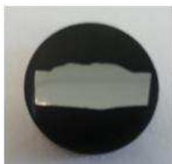
Figura 3.18: Corpo-de-prova para realização do ensaio ASTM A-262 - Prática A.
