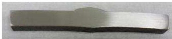
Figura 3.21: Corpo-de-prova para realização do ensaio ASTM A-262 - Prática E.
