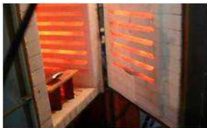
Figura 3.12: Forno tipo "câmara" para execução de tratamentos térmicos.
