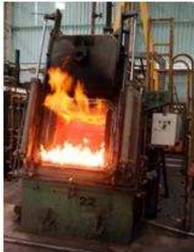
Figura 3.16: Forno tipo “T” para realização de tratamento de estabilização.
