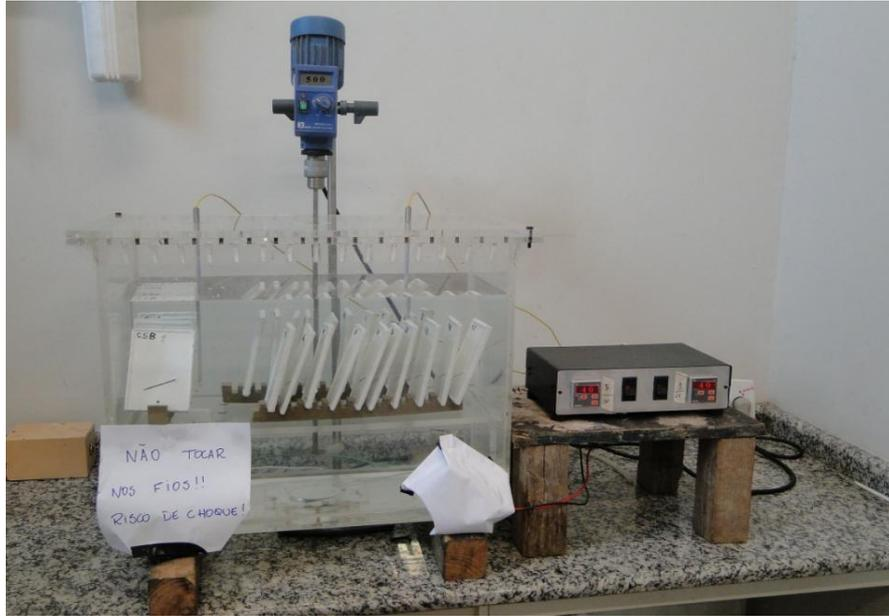
**Figura 27** Aparato experimental para o ensaio de imersão.
