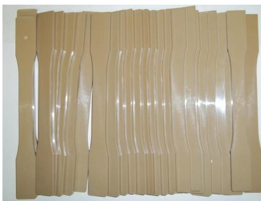
**Figura 31:** Corpos de prova de PEEK 450 G, Tipo I (ASTM D 638), empregados nos ensaios de envelhecimento químico.
