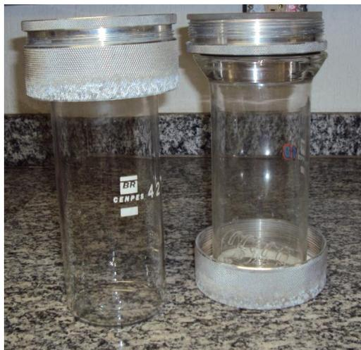
**Figura 32:** Reatores empregados na realização dos ensaios de envelhecimento químico dos polímeros.
