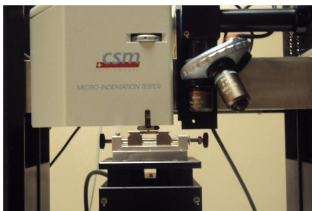
**Figura 43:** Sistema para realização das análises de microdureza por microindentação instrumentada.
