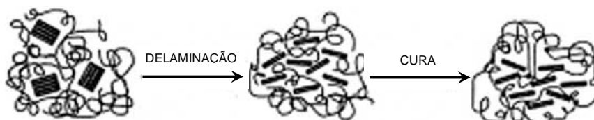
Figura 2.13 – Ilustração esquemática da obtenção de nanocompósitos.
