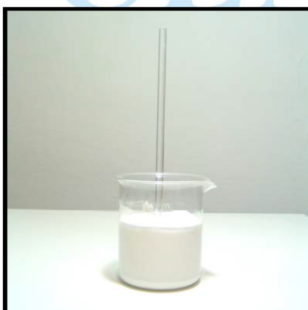
Fig.4: Nanolite ® ER - 9025 : Suspensão a 10 % p/p após 30 seg. em repouso
