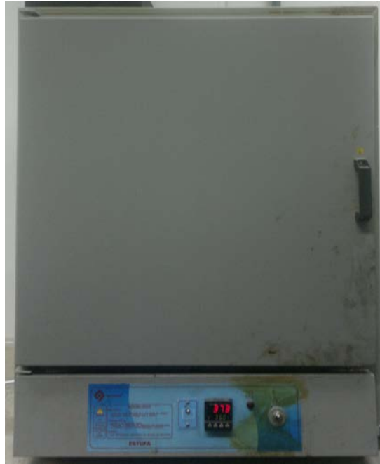
Figura 3.2 – Estufa utilizada para aquecimento dos moldes e cura das amostras de resina epóxi pura e dos nanocompósitos.
