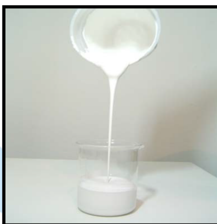
Fig. 3: Nanolite ® ER - 9025 : Suspensão a 10 % p/p após cisalhamento
