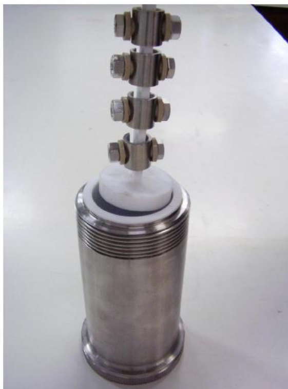
Figura 17: Detalhe da inserção do dispositivo de suporte com os quatros corpos de prova na autoclave cilíndrica.
