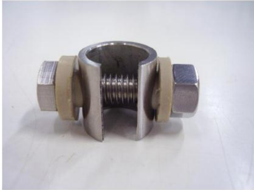
Figura 13: Detalhe do corpo de prova, usinado a partir de tubos de diferentes materiais, montado com o parafuso de tensionamento e o isolamento para evitar o efeito galvânico durante o ensaio.
