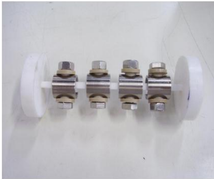
Figura 16: Detalhe do suporte com o conjunto de quatro anéis de aço inoxidáveis a serem submetidos simultaneamente a uma condição de ensaio.
