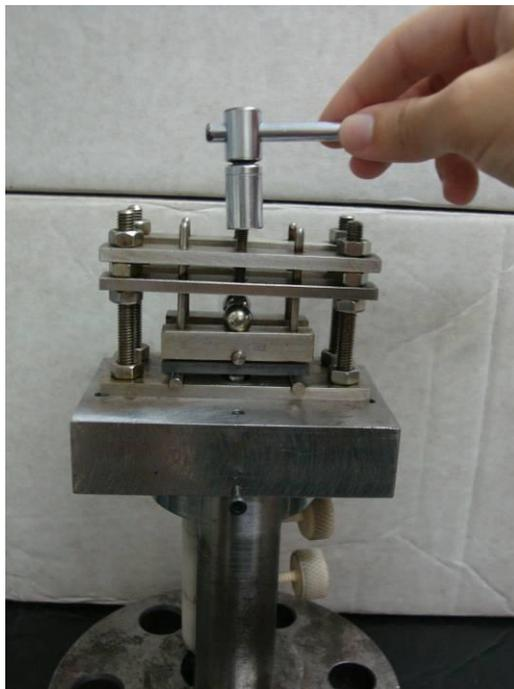
Figura 14 - Dispositivo LVDT; Aplicação de deflexão no corpo de prova
