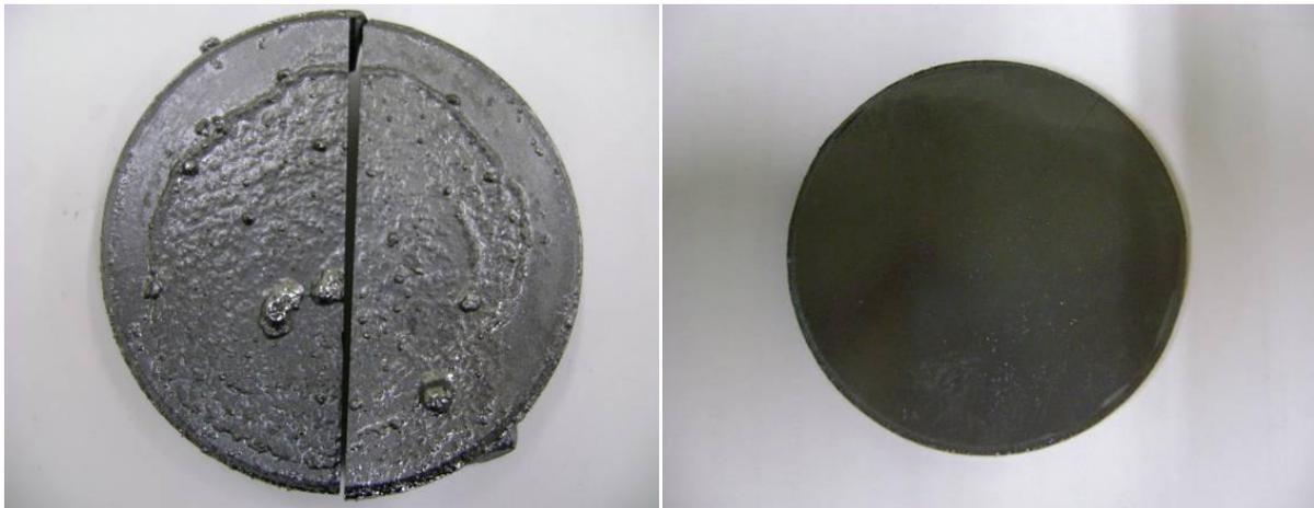
Figura 26 - Amostra infiltrada originada da composição C4. Lado esquerdo: amostra ainda recoberta com silício e cortada; Lado direito: amostra retificada para remoção do silício residual.
