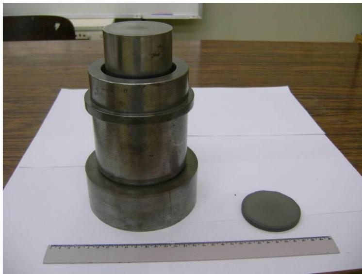
Figura 6 – Molde e corpo-verde prensado
