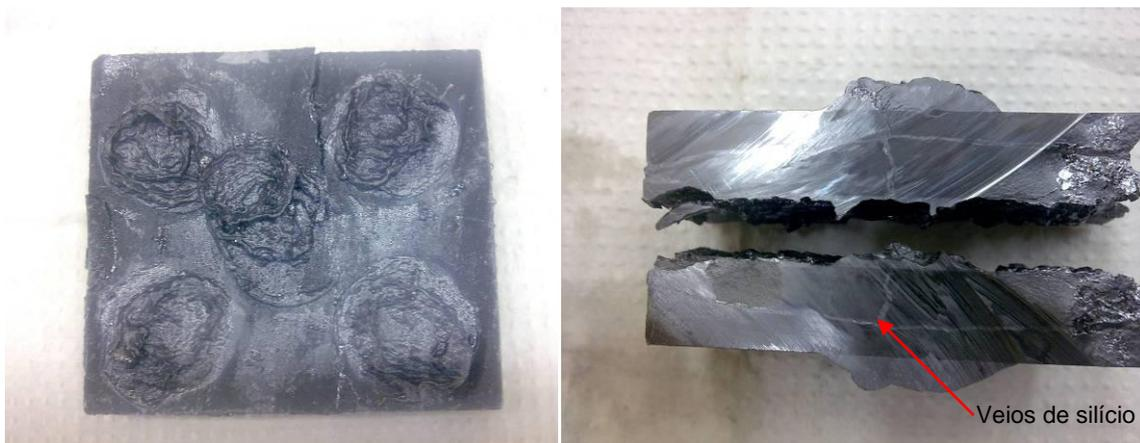
Figura 25 - Amostra infiltrada originada da composição C3.
