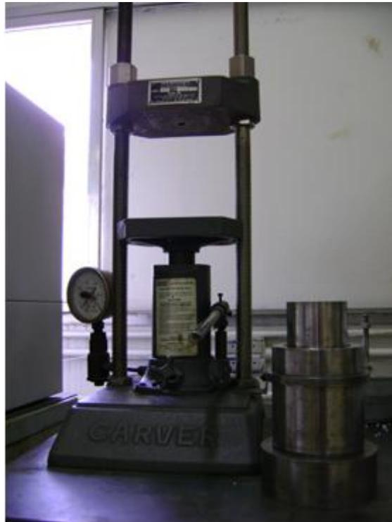
Figura 5 - Prensa e molde utilizados para prensagem uniaxial.
