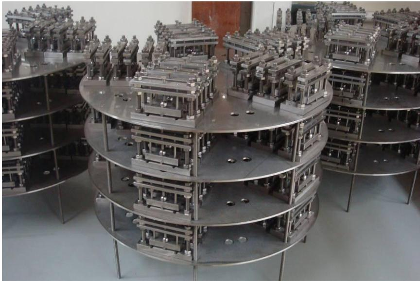
Figura 15 - Bandejas para posicionamento dos dispositivos de flexão utilizados na degradação.
