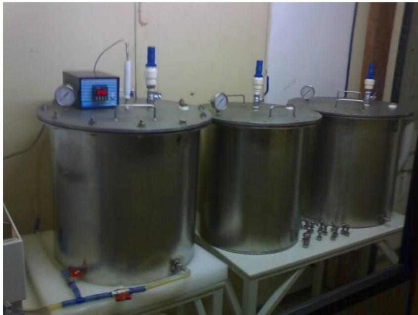
Figura 16 - Tanques utilizados para degradação do material.
