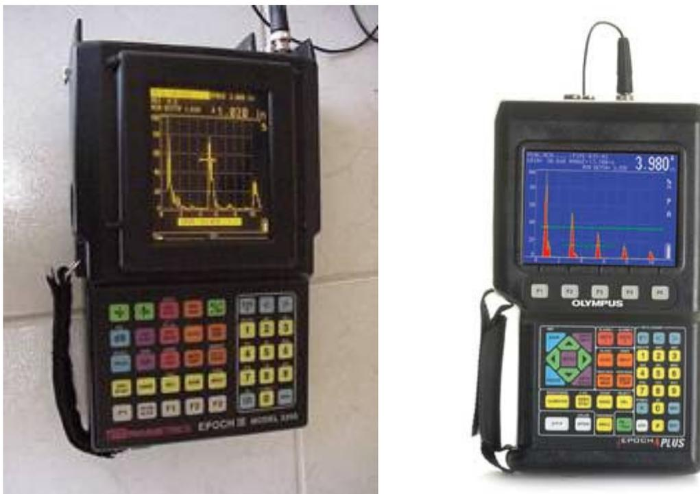
Figura IV.12 – Aparelhos ultrassônicos utilizados
