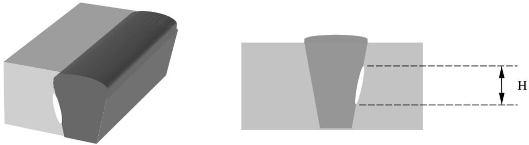
Figura IV.3 – Representação esquemática do tipo de defeito falta de fusão
