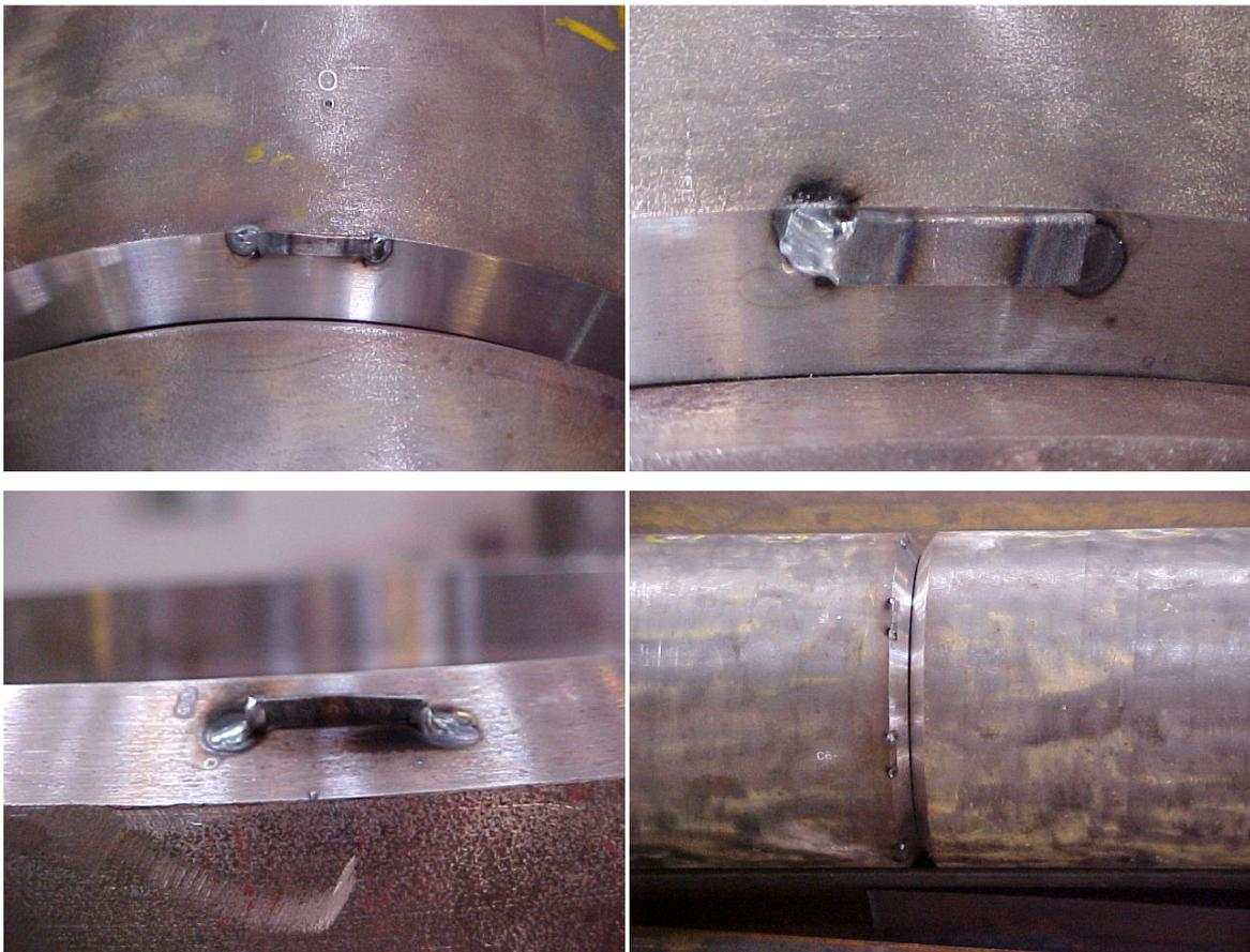
Figura IV.4 - Metodologia empregada para simular defeitos de falta de fusão
