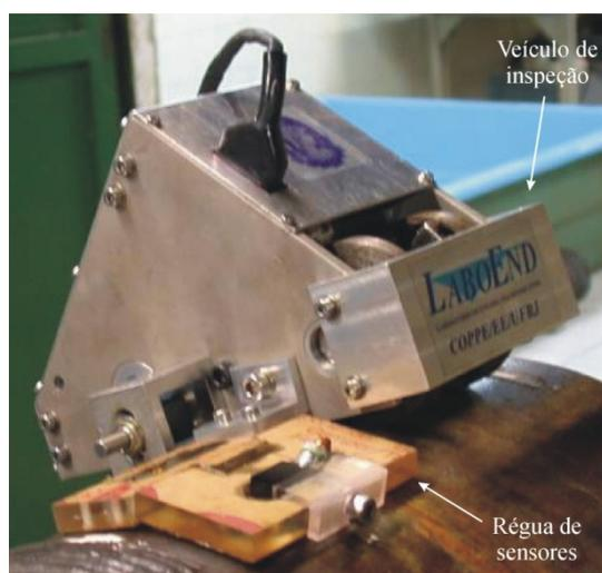
Figura IV.7 - Veículo de inspeção
