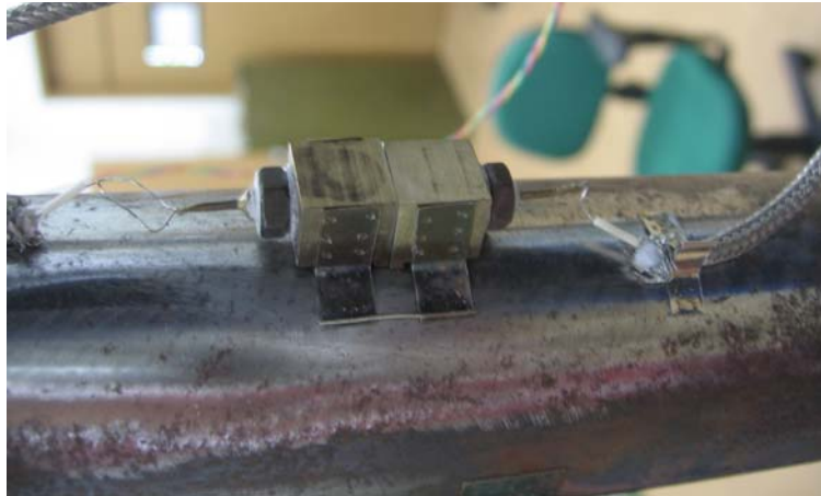
Figura 4.1.4 – Extensômetro capacitivo SJB, soldado no tubo para ensaio de tração
