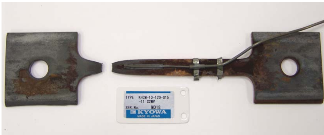
Figura 4.2.3 – Amostra CP600_150_1: ensaio a 600°C e tensão de 150 MPa. A estricção e o rompimento do corpo de prova ocorreram fora da região onde o extensômetro estava soldado.
