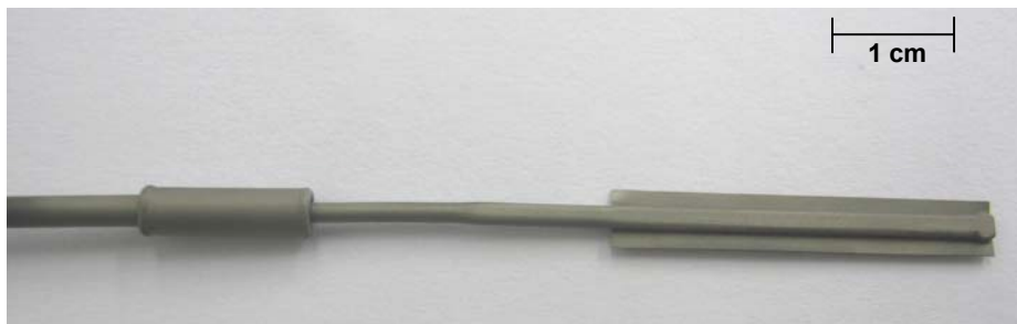
Figura 3.2.2 – Foto do extensômetro Kyowa modelo KHCM-10-120-G15-11 C2M
