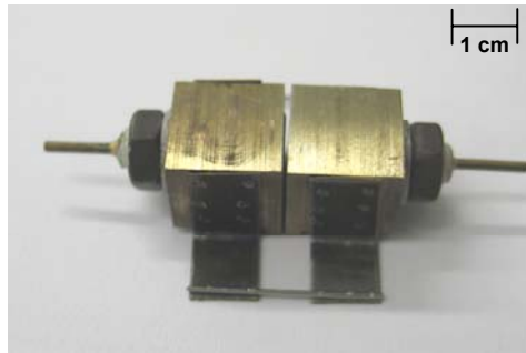
Figura 3.2.5 – Foto do extensômetro capacitivo SJB
