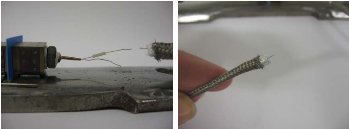
Figura 4.1.5 – Fio rompido do extensômetro.
