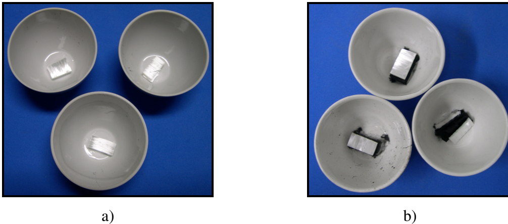
Figura 3.12 - Amostras para determinação de fração volumétrica de fibras, após queima: a) fibras de vidro, b) fibras de vidro e de carbono.
