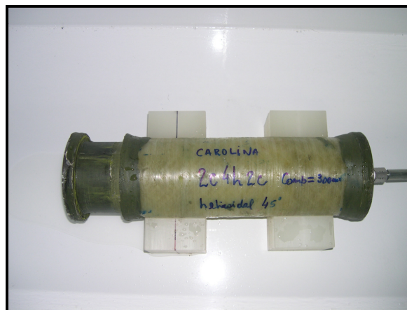
Figura 4.22 - Cabeça de vedação expelida durante ensaio hidrostático.
