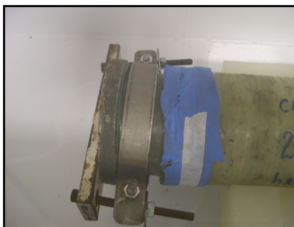
Figura 4.23 - Cabeças de vedação e braçadeiras expulsas durante ensaio hidrostático.
