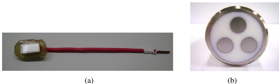
Figura III.1: Eletrodo de trabalho para ensaios eletroquímicos em (a) bancada e (b) Loop.
