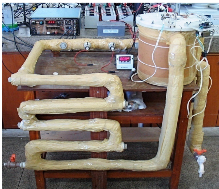
Figura III.4: Sistema de circuito fechado Loop (80°C)
