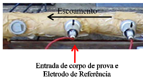
Figura III.7: Esquema de montagem dos ensaios de polarização no circuito de sistema fechado Loop (80°C).
