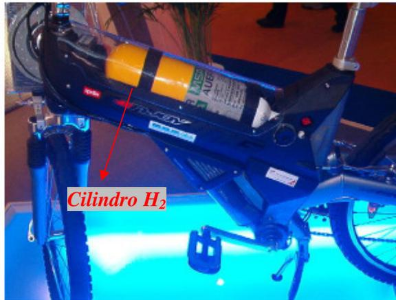
Fig. 2.2. Fotografia de um armazenador de hidrogênio sob a forma de gás comprimido, feito de compostos de carbono aplicado a uma bicicleta elétrica apresentada na Feira de Hannover em abril de 2003. Adaptado de Dos Santos et al. [3].
