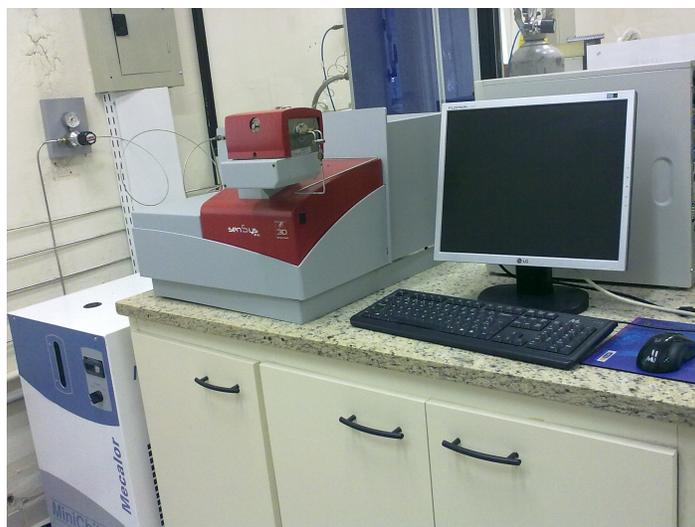
Fig. 3.4. Imagem do equipamento de DSC montado no laboratório PROPMEC.
