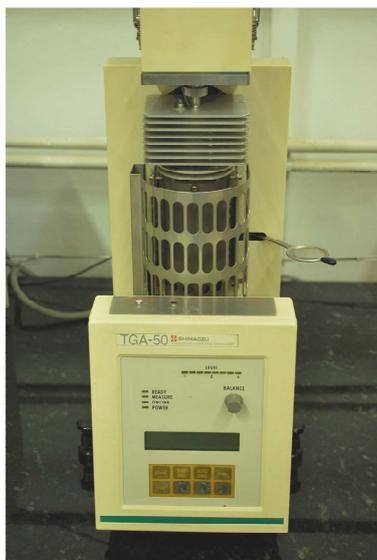
Figura 8 - Equipamento de análise termogravimétrica (TGA).
