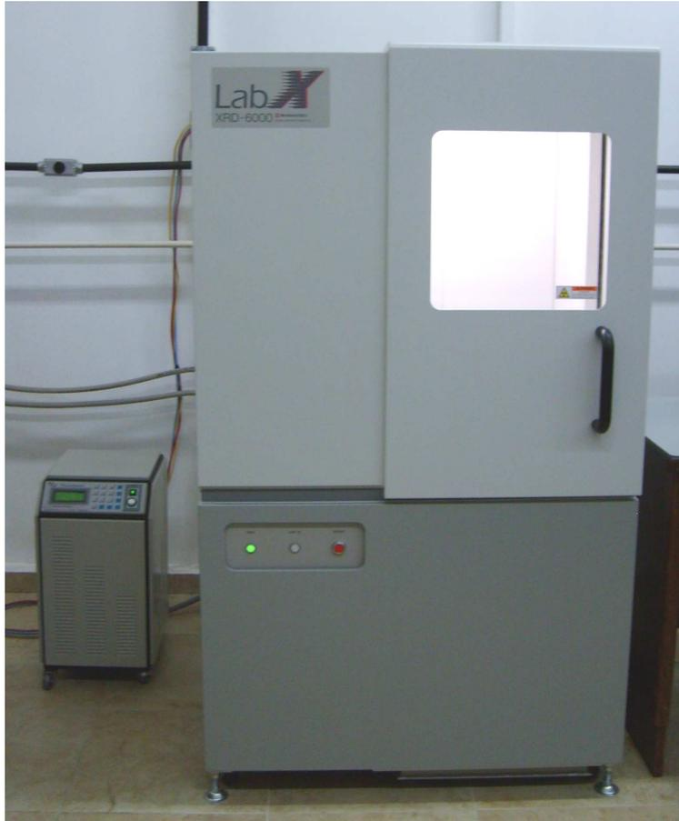
Figura 9 - Difratorômetro de raios-X.
