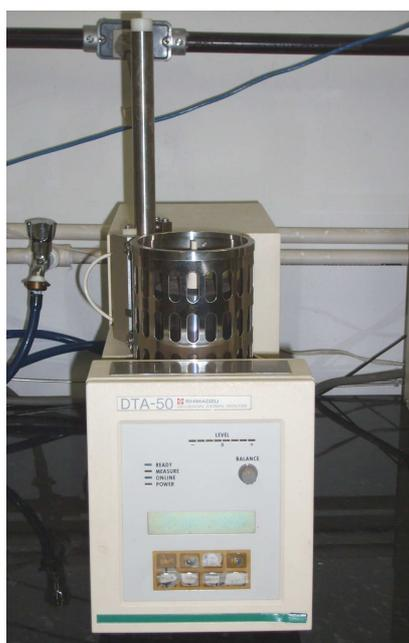
Figura 7 - Equipamento de análise térmica diferencial (DTA).
