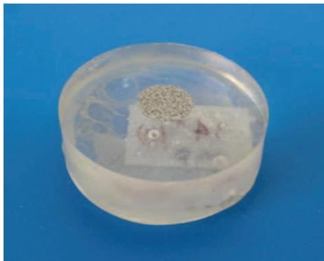
Fig. 3.10 - Substrato TiP embutido em resina para posterior polimento metalográfico.
