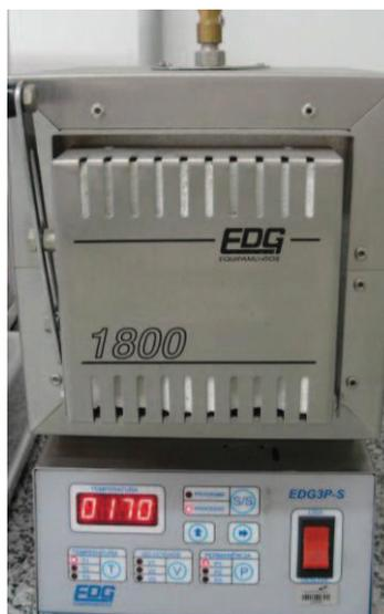
Fig. 3.17 – Forno, em aquecimento, para tratamento térmico das amostras.
