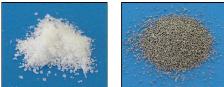
Fig. 3.1 - matéria-prima: (a) pó de BA; (b) pó de Ti.
