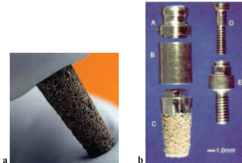
Fig. 2.6 - Titânio poroso: (a) Protótipo de implante dentário poroso (adaptado de NRC-IMI/Quebec); (b) Implante de liga de titânio com superfície porosa (adaptado de Faculty of Dentistry/Toronto University).
