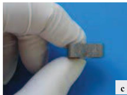
Fig. 3.6 - (a) Punção quadrado e substrato obtido por compactação uniaxial; (b) Imagem do substrato TiM, visão superior; (c) Imagem do substrato TiM, visão lateral.
