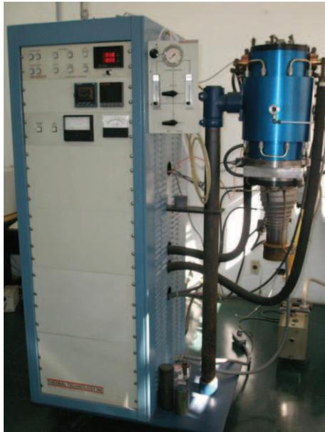
Fig. 3.5 - Forno a vácuo (*Thermal Technology – modelo ASTRO*).
