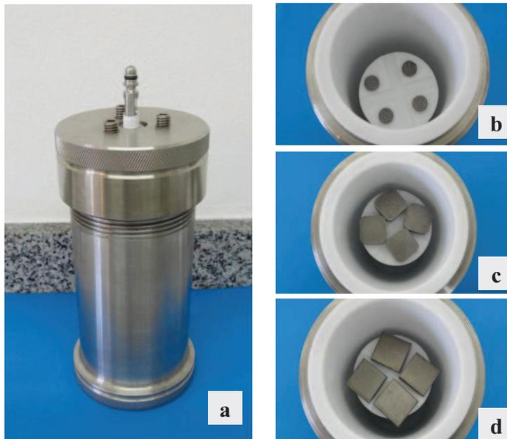
Fig. 3.16 - (a) Mini-autoclaves; substratos posicionados no interior das mini-autoclaves para tratamento químico com NaOH: (b) TiD, (c) TiM e (d) TiP.
