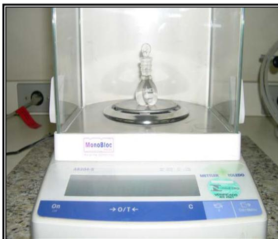
Figura 15 – Picnômetro sendo pesado na balança analítica de precisão *METTLER TOLEDO*
