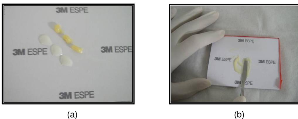
Figura 12: (a) Três doses das pastas base e catalisadora do cimento RelyX™U100 e (b) manipulação do cimento.
