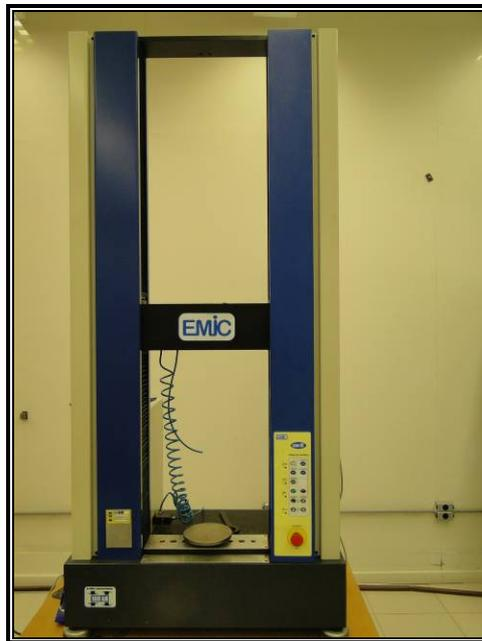
Figura 17: Máquina de ensaios mecânicos universais EMIC DL 10000
