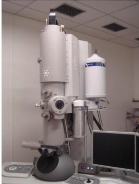
**Figura 12 – Microscópio eletrônico de transmissão utilizado nas análises, FEI Tecnai G20.**
