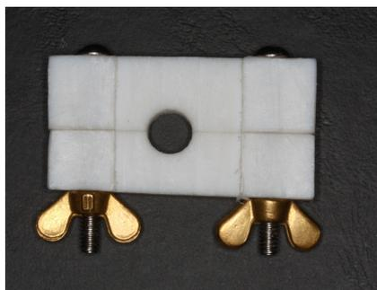
**Figura 18:** matriz bipartida com aparatos de estabilização para confecção dos corpos de prova para os ensaios de contração (7mm X 5mm).
