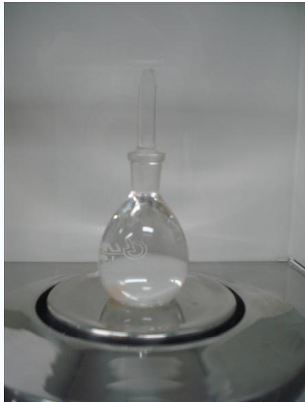
**Figura 24:** Picnômetro de 25 ml - marca:Laborglass.
