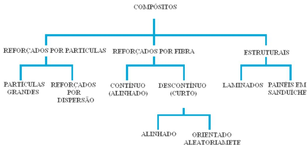
**Figura 1** - Classificação dos compósitos quanto ao tipo de reforço
