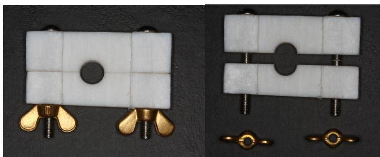
**Figura 19:** matriz bipartida com aparatos de estabilização para confecção dos corpos de prova para os ensaios de dureza (7mm X 5mm).
