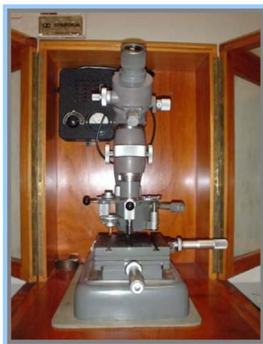
**Figura 26:** Microdurômetro para o ensaio de dureza
