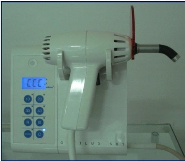
**Figura 13** – Unidade de ativação por luz halógena com lâmpada de quartzo de tungstênio- QTH Optilux<sup>TM</sup> 501 - Demetron® (Kerr, United States of America,USA);
