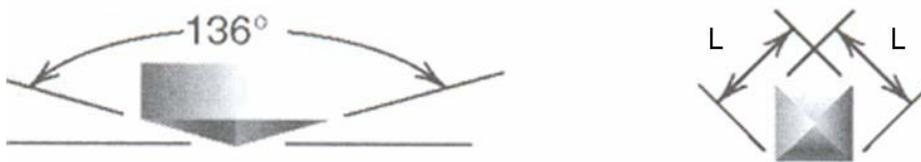
**Figura 5:** Identador da Microdureza Vickers (CALLISTER, 2002).
