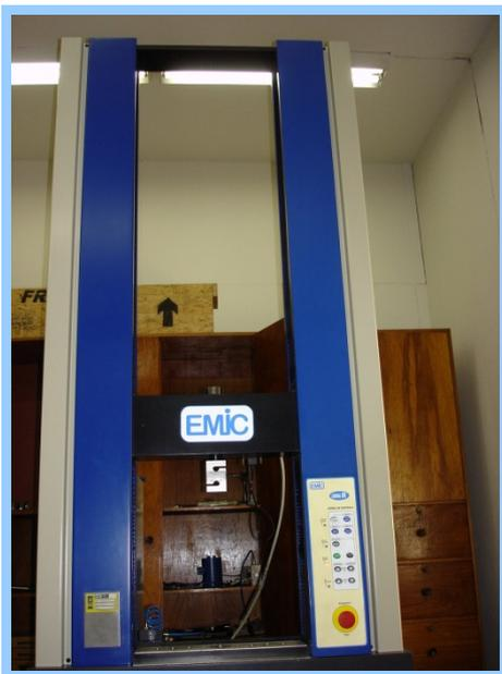
**Figura 27:** Máquina EMIC onde foram realizados os ensaios de resistência à compressão diametral.
