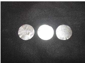
**Fig. 40** – Corpos de prova usinados
