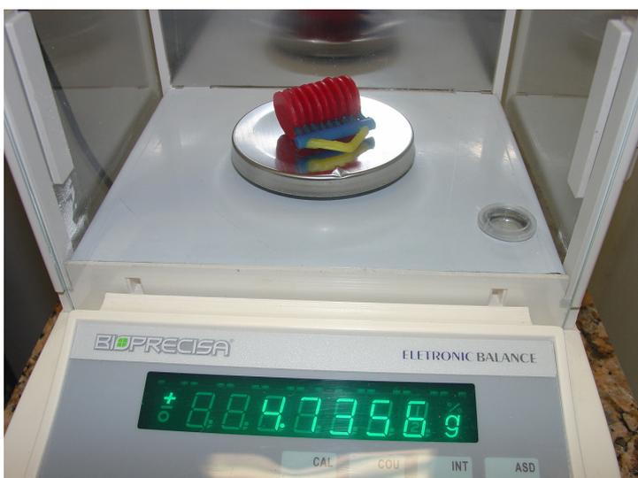
**Fig. 28** – Corpo de prova sendo pesado
