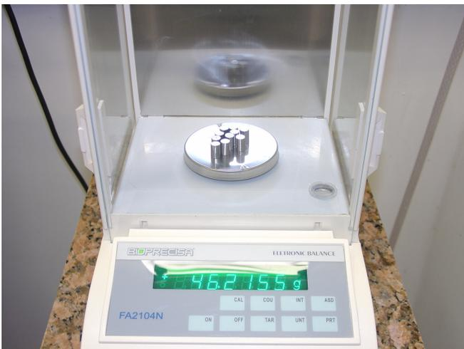
**Fig. 30** – Liga metálica sendo pesada
