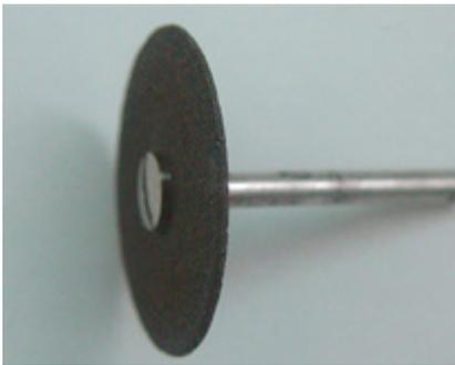
**Fig. 39** – Disco de corte carborundum
