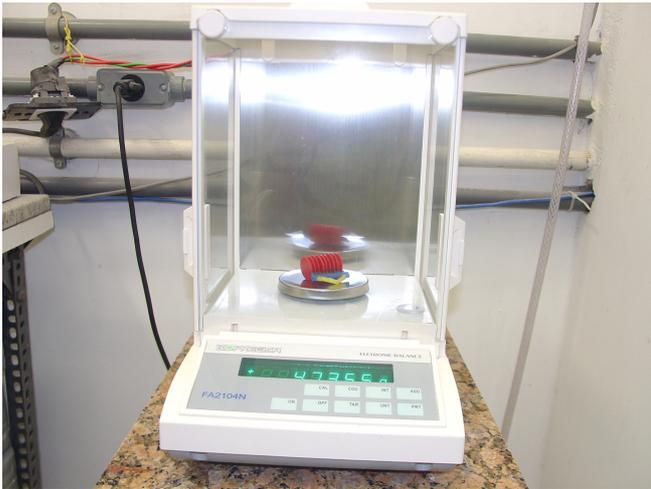
**Fig. 29** – Balança de precisão
