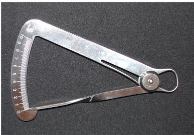
**Fig. 43** – Paquímetro utilizado para medir os corpos de prova
