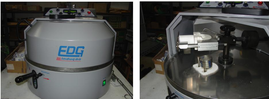
**Fig. 34** – Centrífuga por indução Powercast 1700 (EDG)
