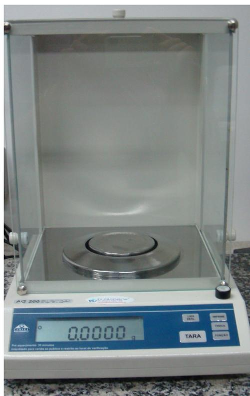
Figura 10 - Balança analítica de precisão.
