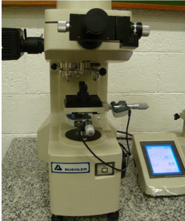
Figura 7 – Microdurímetro utilizado para o ensaio de microdureza Vickers.
