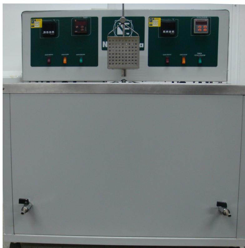
Figura 6 – Máquina utilizada para fazer a termociclagem.
