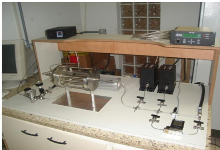
Figura 3.5: Foto do equipamento utilizado para as medidas de permeação gasosa de hidrogênio.
